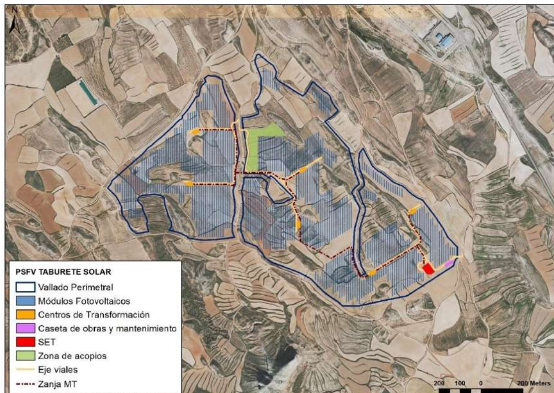
Imagen 3. Emplazamiento de la PSFV Taburete sobre ortofoto.
