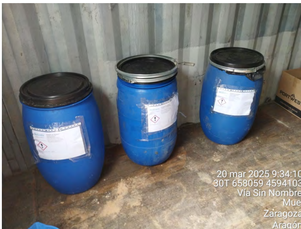
Fotografía 4. Bidones estancos de residuos peligrosos bajo techado
