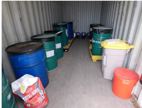
Imagen 19. Depósitos homologados adecuadamente identificados situados en el interior del punto limpio para el depósito temporal de residuos peligrosos
