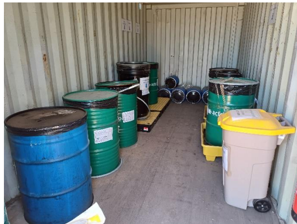
Imagen 22. Depósitos homologados adecuadamente identificados situados en el interior del punto limpio para el depósito temporal de residuos peligrosos
