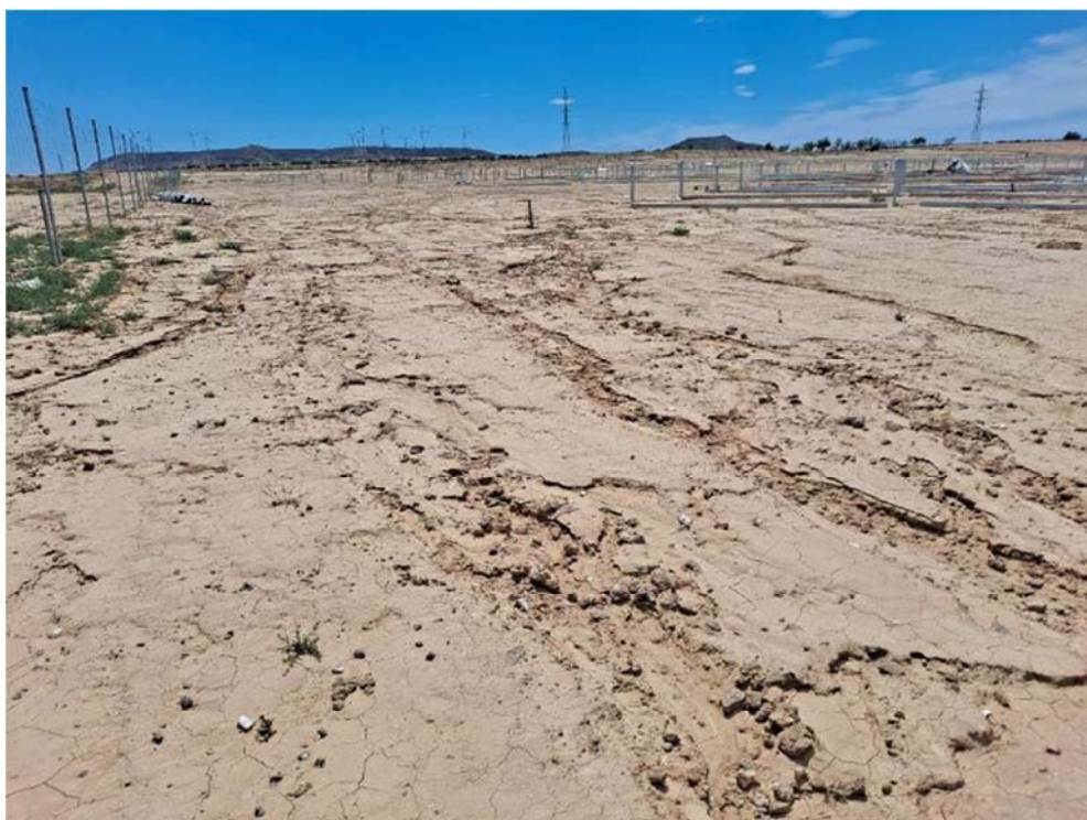
Figura 8.16. Abundantes regueros activos debido a la escorrentía superficial, que discurren por el sector suroriental de la planta
