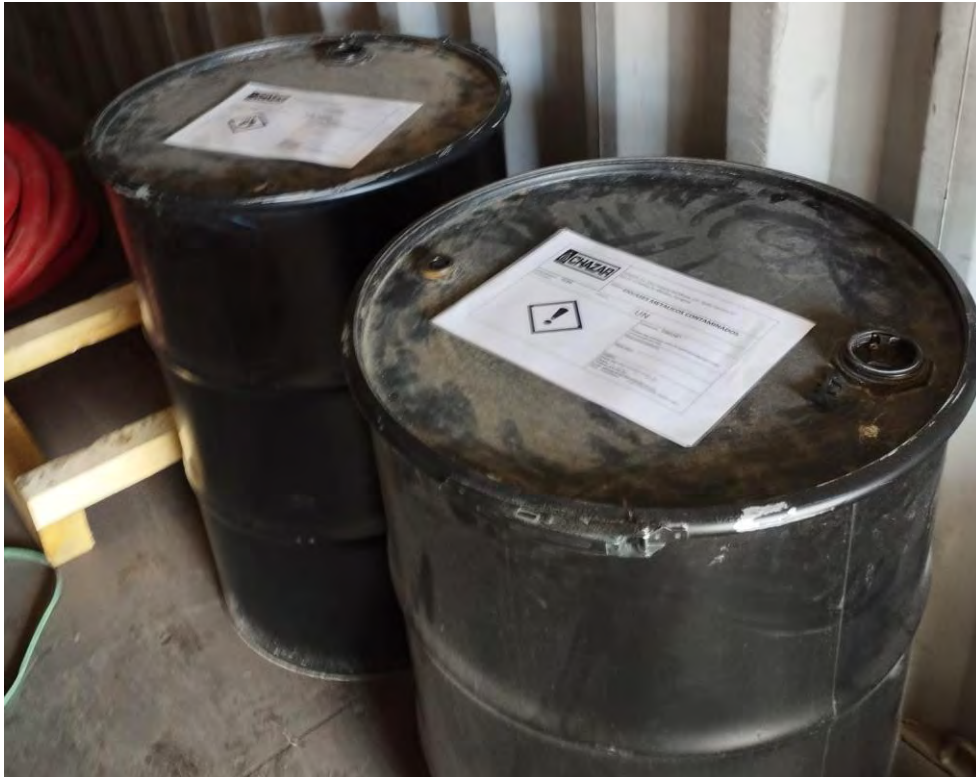
Ilustración 10. Bidones de cierre ballesta de 200 litros destinados al almacenamiento de residuos peligrosos
