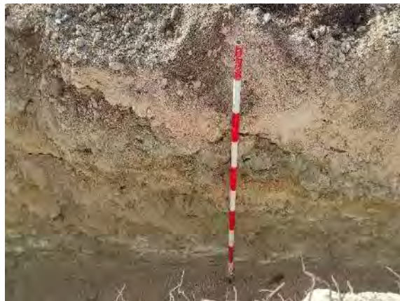
Fotografía 12: Estratigrafía de la zanja de evacuación de la PFV Mitra
