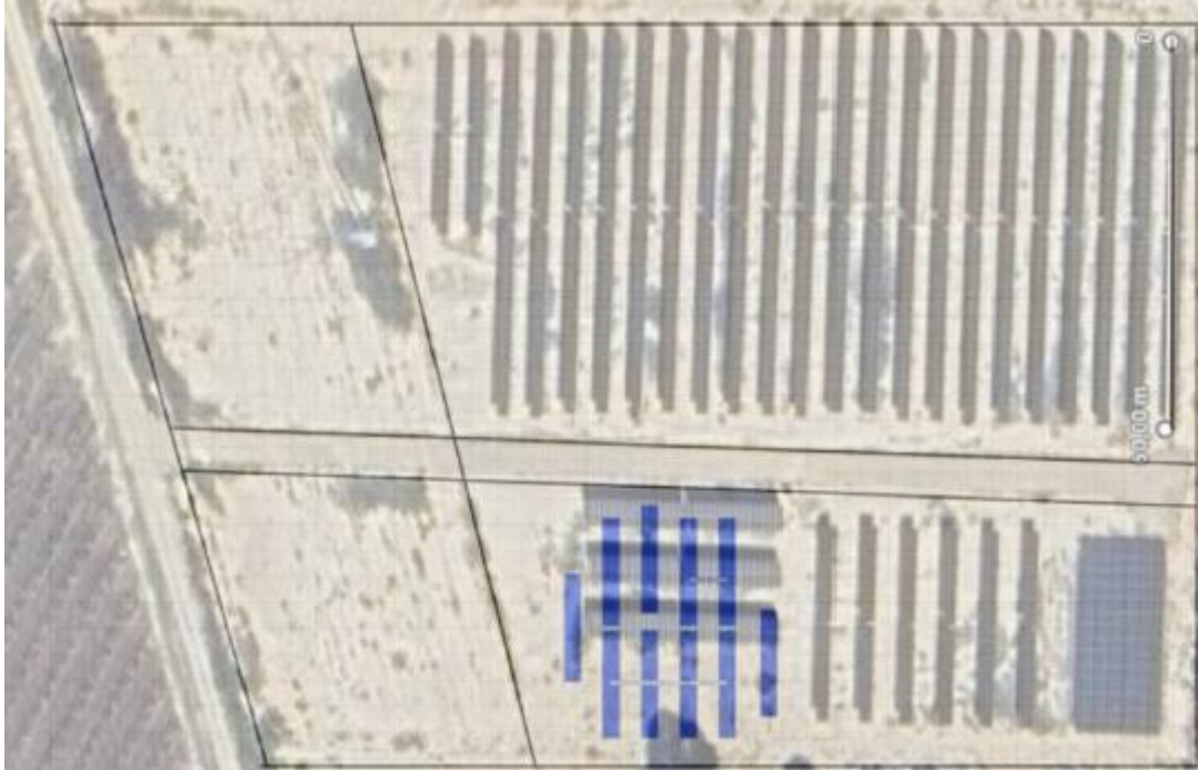
Figura 2.1. Sustitución de estructuras fijas este-oeste por seguidores norte-sur en el recinto sur (Campo I+D).
