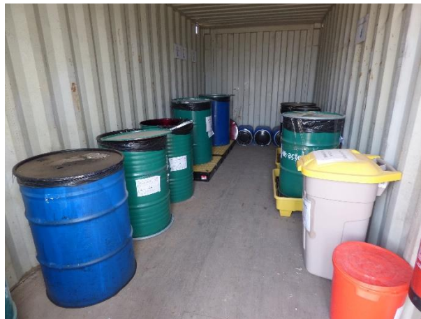
Imagen 23. Depósitos homologados adecuadamente identificados situados en el interior del punto limpio para el depósito temporal de residuos peligrosos
