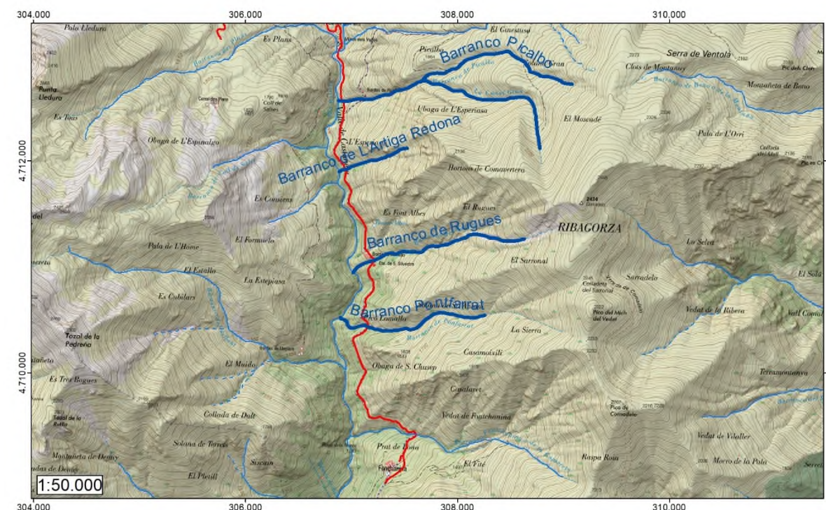
Figura 88. Barrancos en los que se han producido aludes con antelación que pueden afectar a la carretera proyectada (PIGA 2009). En rojo, carretera proyectada. Base cartográfica MTN25. UTM ETRS89 huso 31.
