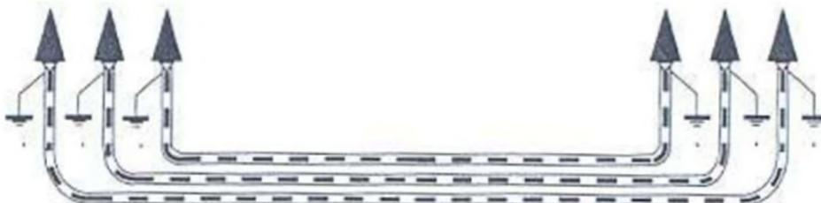
Ilustración 9. Puesta a tierra cubiertas metálicas
