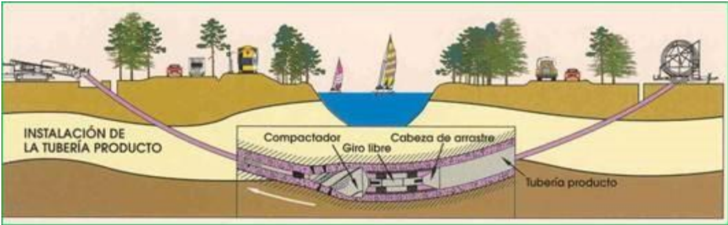
Figura 3.4-4: Instalación de la tubería. Fuente: AECOM, 2024.
