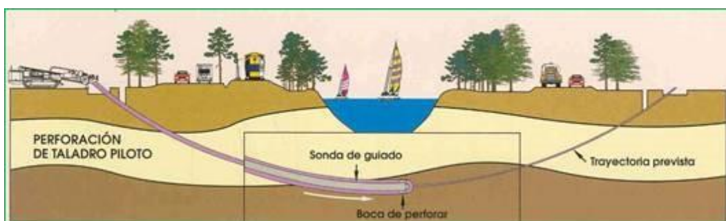
Figura 3.4-2: Perforación de taladro piloto.
