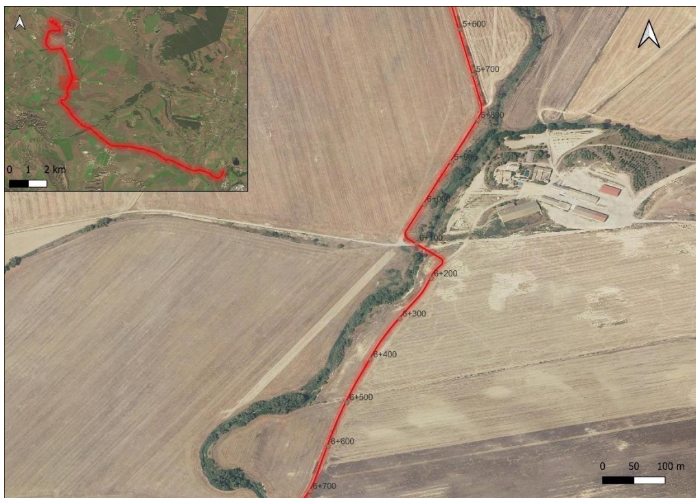
Figura 7.4-4: Detalle del cruce del trazado de la línea soterrada a la altura del río Sotón, en el PK 6+100, mediante perforación horizontal dirigida. Fuente: AECOM, 2024.
