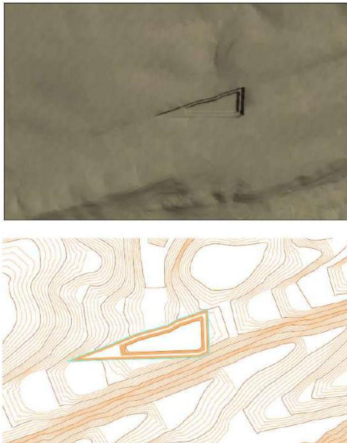
**Figura 8.** Simulación 3D y curvado de situación de la Zona II de la Ampliación Segunda a “Valdecastillo” n° 5470 con el hueco de explotación de la Zona II (contorno azul en el curvado).
