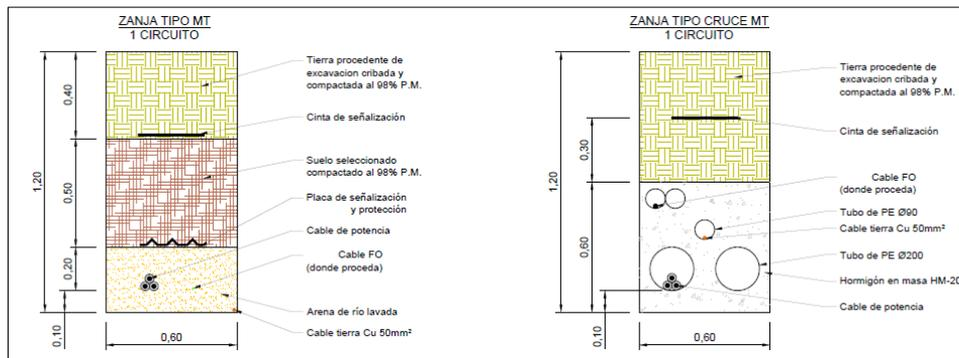
Ilustración 2: Secciones tipo zanja
