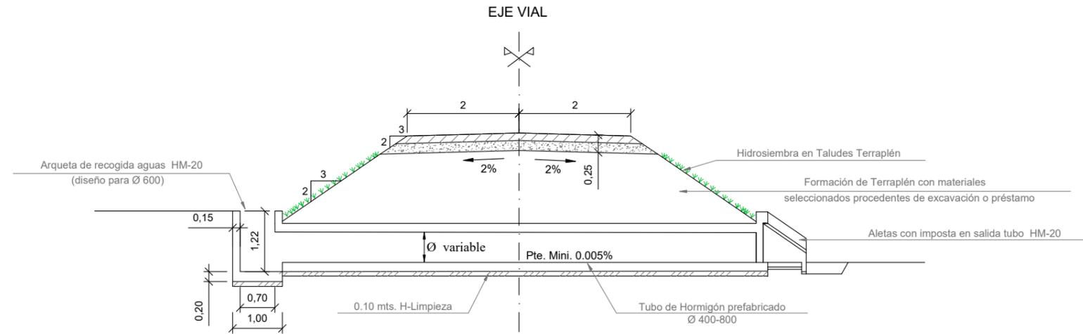
SECCIÓN TIPO VIAL EN TERRAPLÉN (SECCIÓN TIPO CON OBRA DRENAJE)
