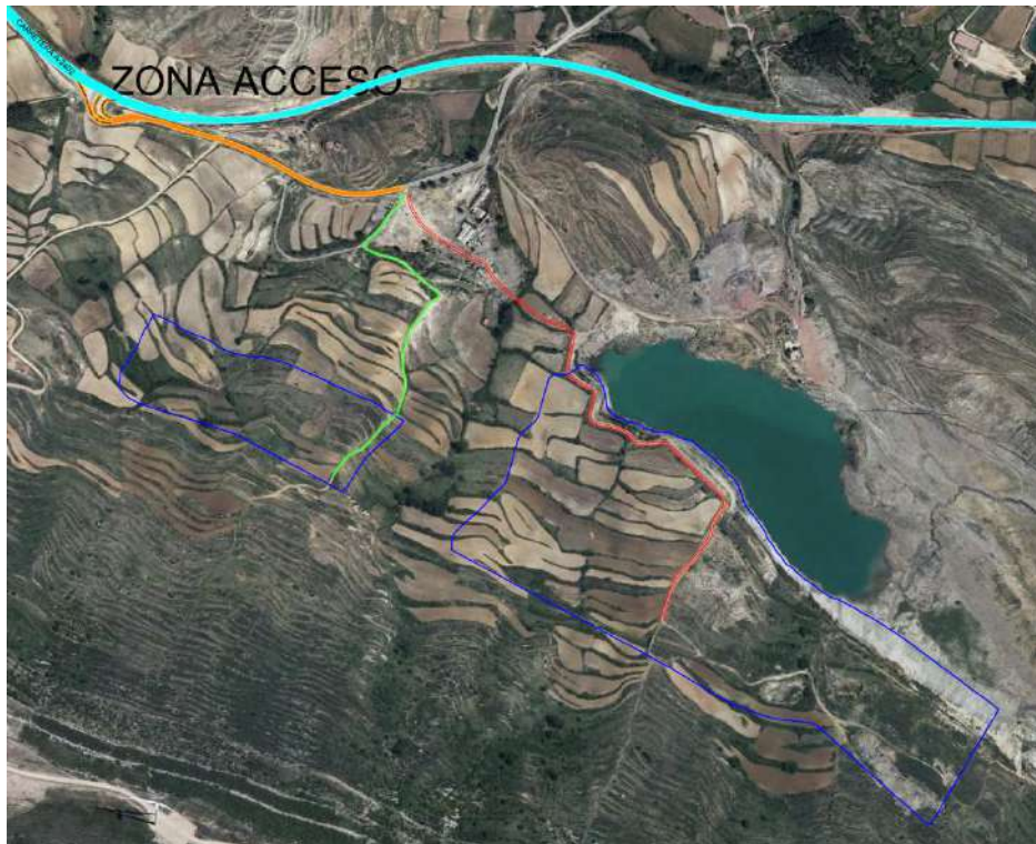
Figura 7. Accesos desde las antiguas instalaciones de Minas Palomar a las zonas de explotación definidas. En verde el acceso, por un camino existente a la Zona 2 y en rojo, por caminos existentes, el acceso a la Zona 1.
