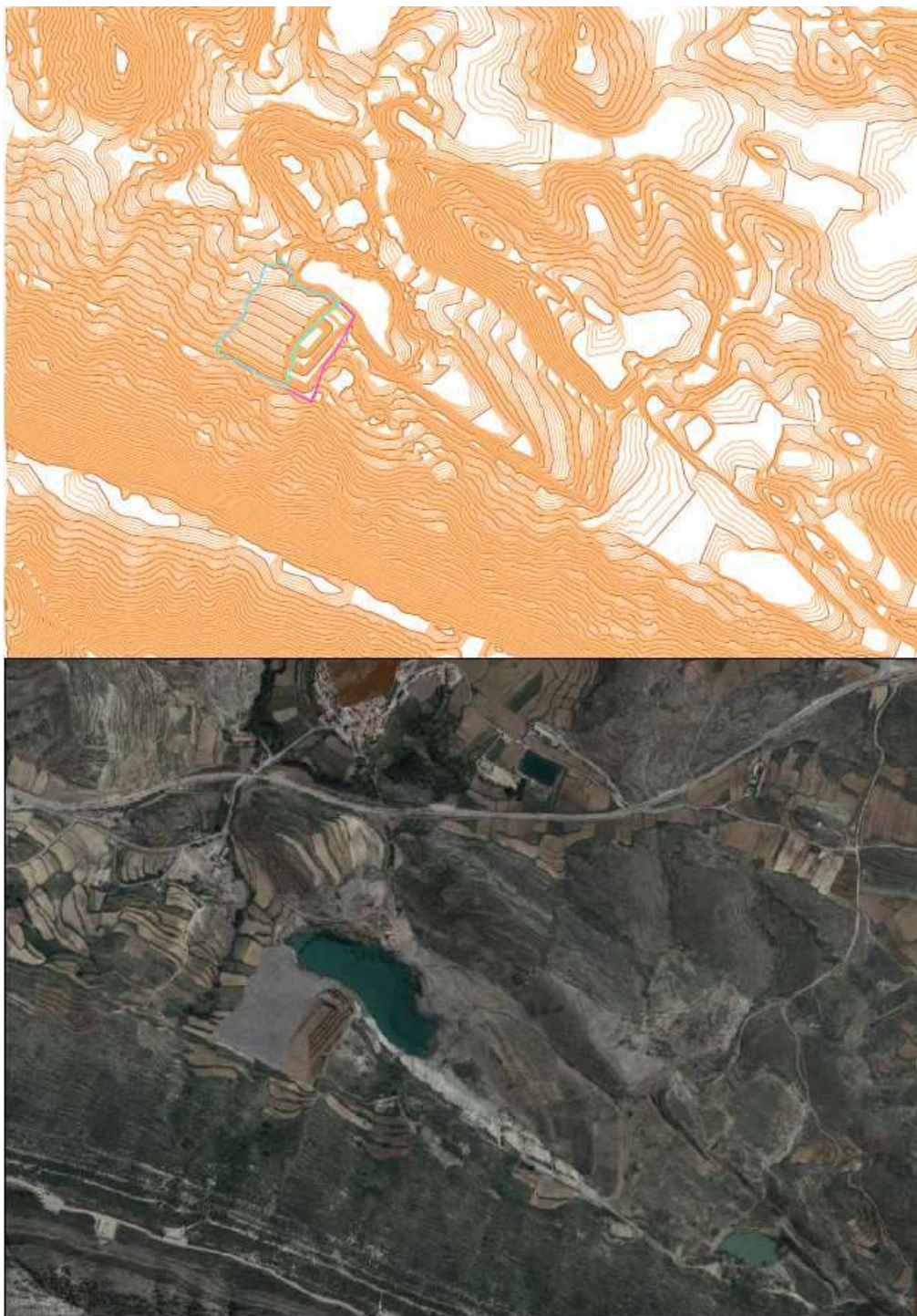
Figura 66. Restauración de la Fase I de explotación con hueco de explotación en color magenta en el curvado y trama gris en la simulación 3D. La trama en marrón se corresponde con la zona de explotación que no se puede restaurar para facilitar la prolongación de la explotación hacia el este en la denominada Fase II.
