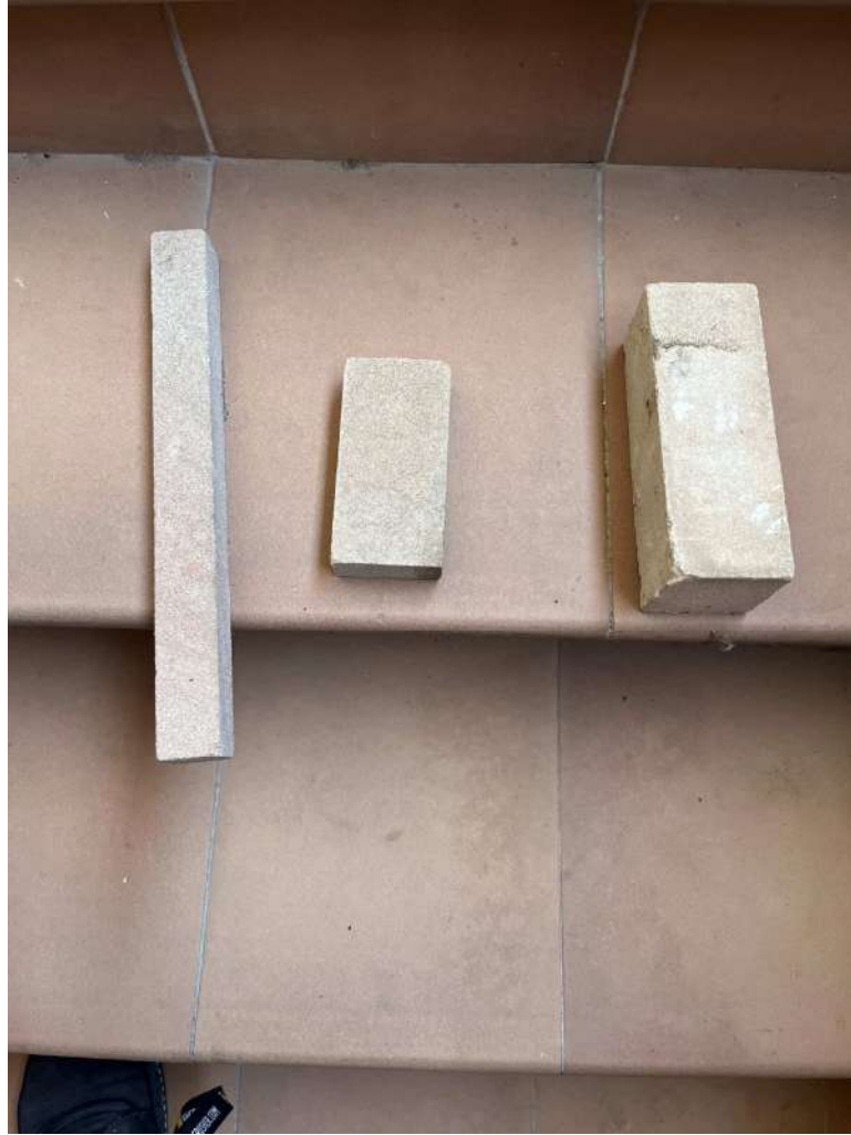
Imagen 10. Detalle de las muestras de areniscas cortadas y pulidas.
