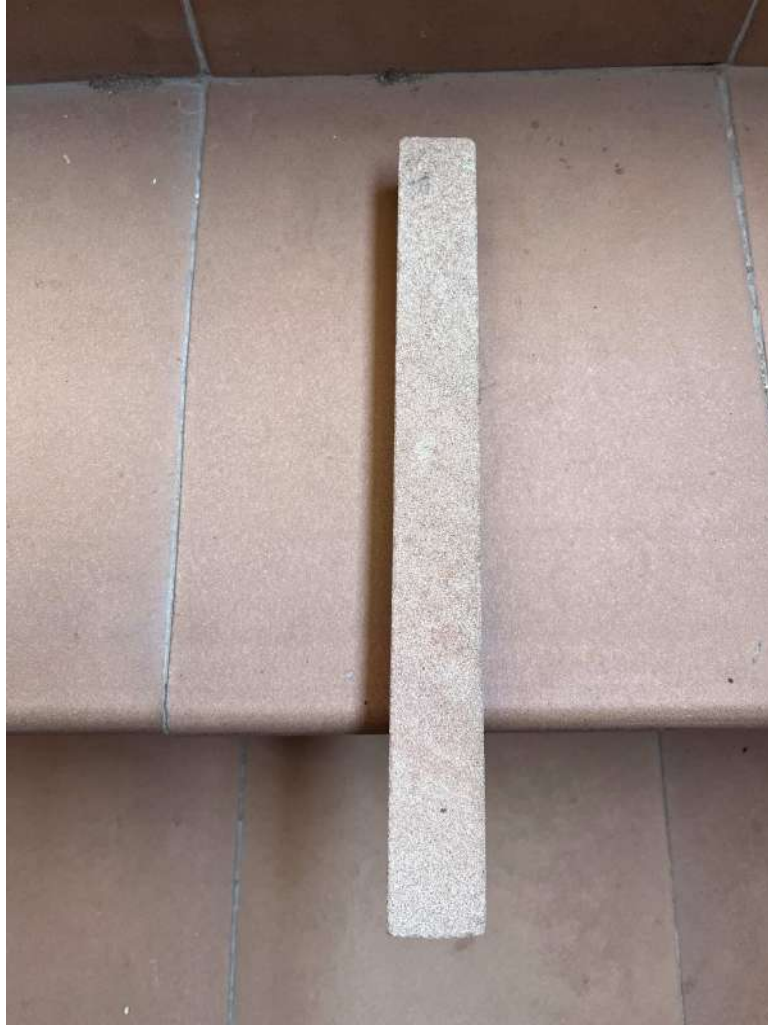
Imagen 8. Muestra de arenisca cortada y pulida.
