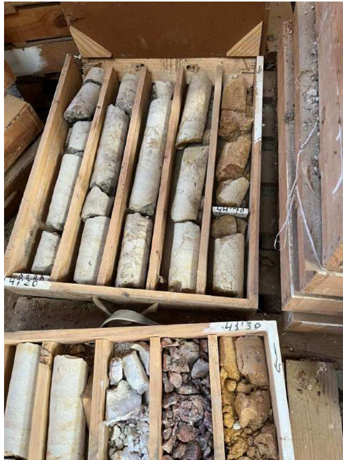
Imagen 12. Detalle de las muestras de areniscas del sondeo 2 sobre las que se van a realizar las analíticas.
