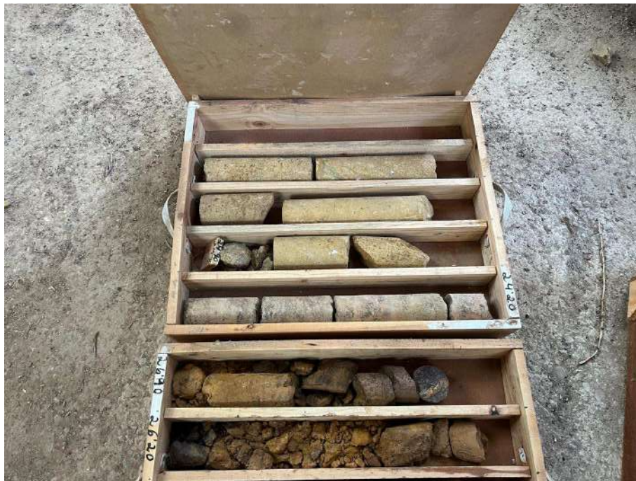
Imagen 16. Detalle de las muestras de areniscas del sondeo 4 sobre las que se van a realizar las analíticas.
