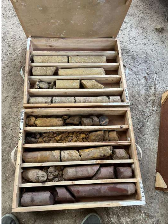
Imagen 15. Detalle de la testificación del sondeo 4.
