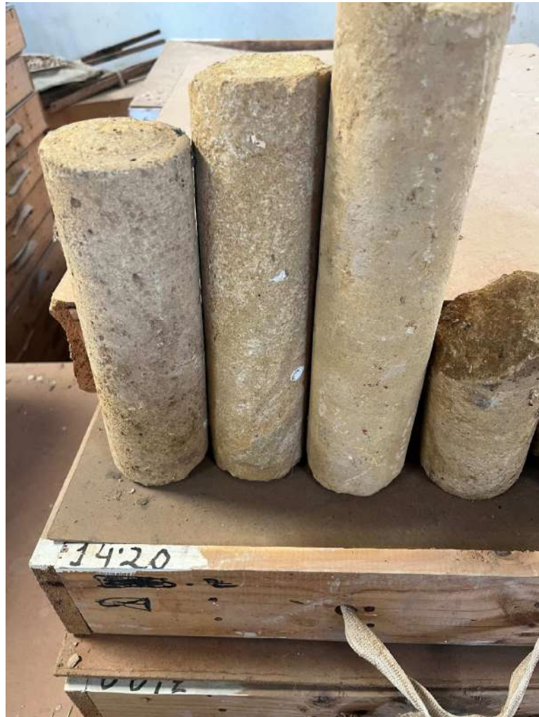
Imagen 6. Muestras de testigo del sondeo 1
