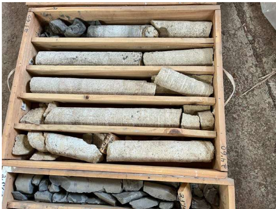
Imagen 14. Detalle de las muestras de areniscas del sondeo 3 sobre las que se van a realizar las analíticas.
