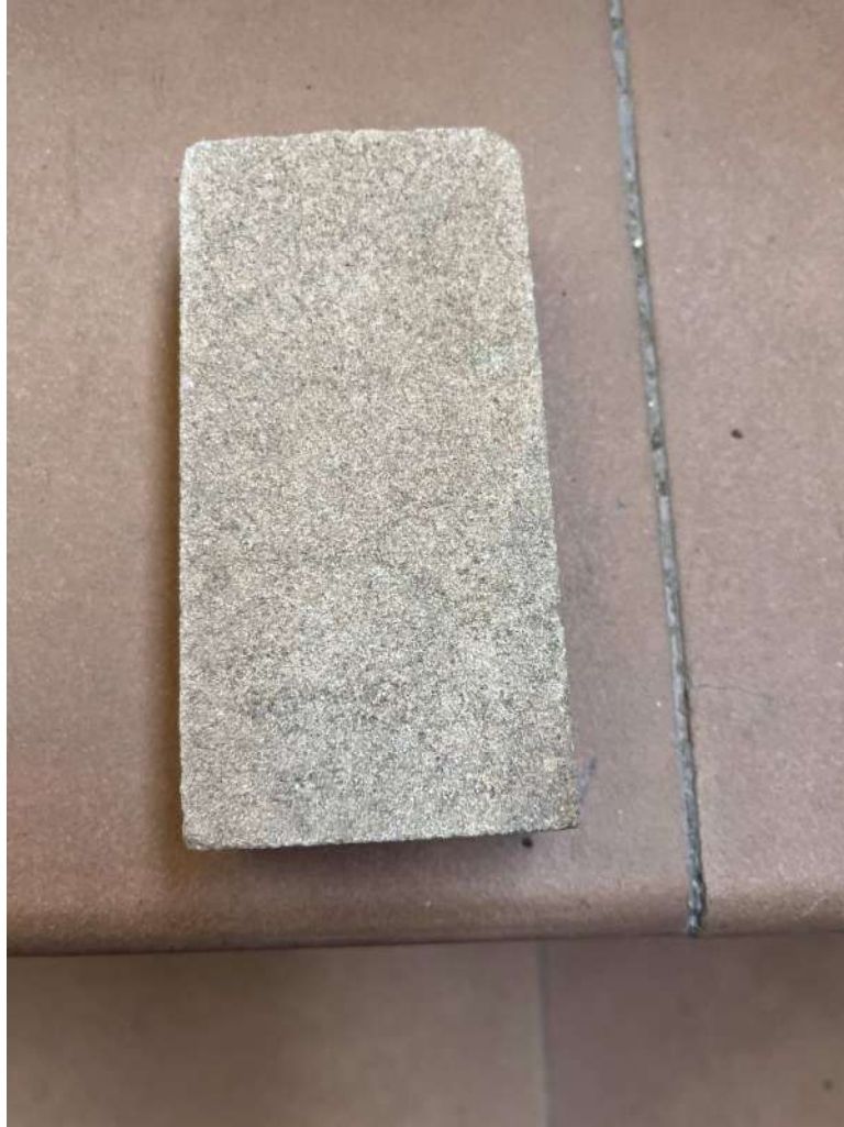
Imagen 9. Detalle de muestra de arenisca cortada y pulida.
