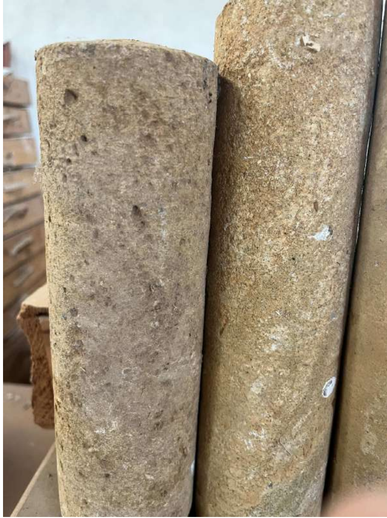
Imagen 7. Detalle de las muestras de areniscas del sondeo 1.
