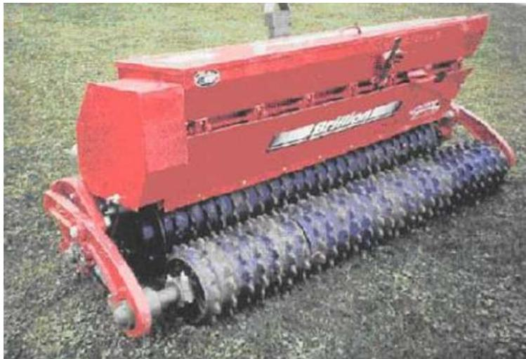
Figura 80: Sembradora para pratenses con rodillos acanalados. Fuente: Ministerio de Agricultura, Pesca y Alimentación
