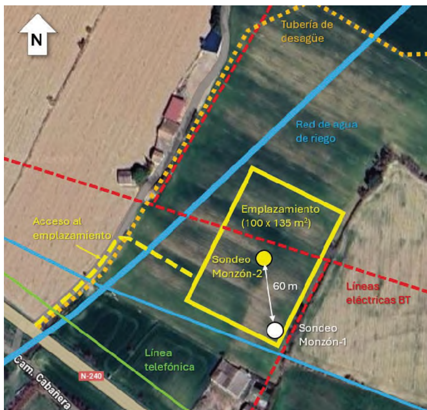
Figura 49. Infraestructura en el entorno del emplazamiento del sondeo Monzón-2
