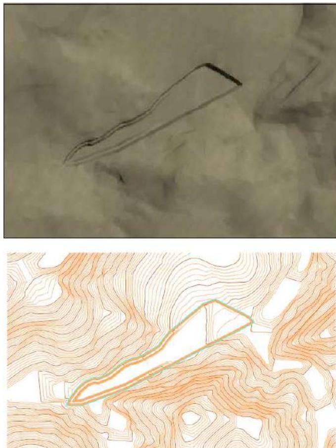
**Figura 70.** Simulación 3D y curvado de situación de la Ampliación Segunda a “Valdecastillo” nº 5470 tras la Zona I de explotación, donde se puede observar lo que será el hueco de explotación de la Zona I (contorno azul).
