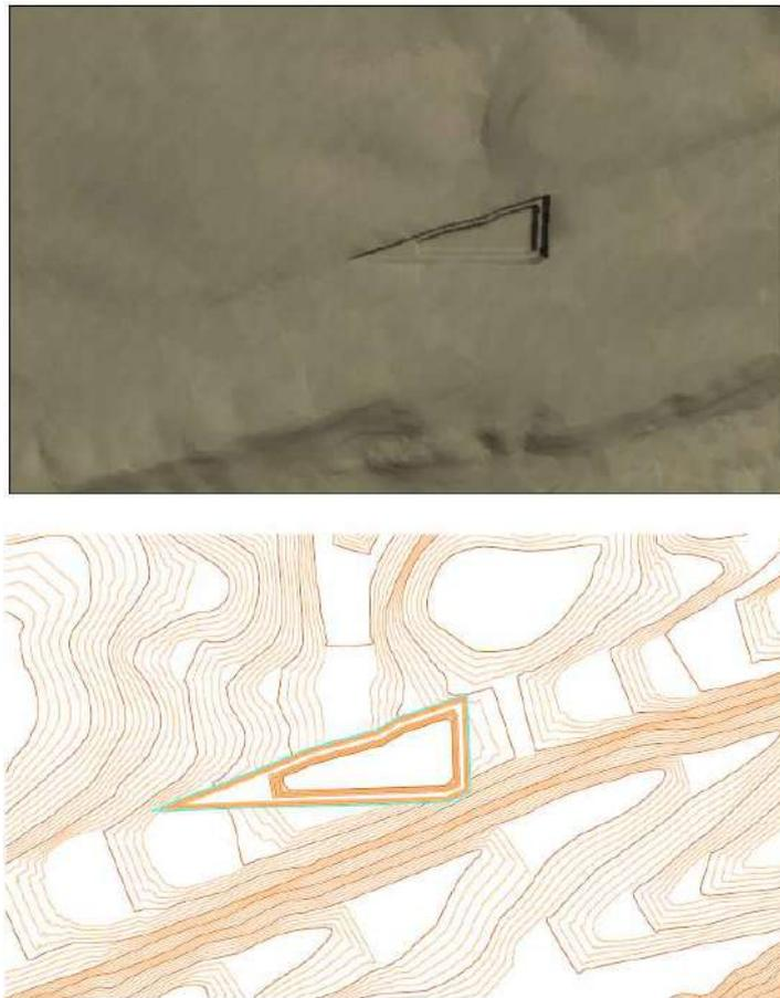
**Figura 72.** Simulación 3D y curvado de situación de la Zona II de la Ampliación Segunda a “Valdecastillo” nº 5470 con el hueco de explotación de la Zona II (contorno azul en el curvado).
