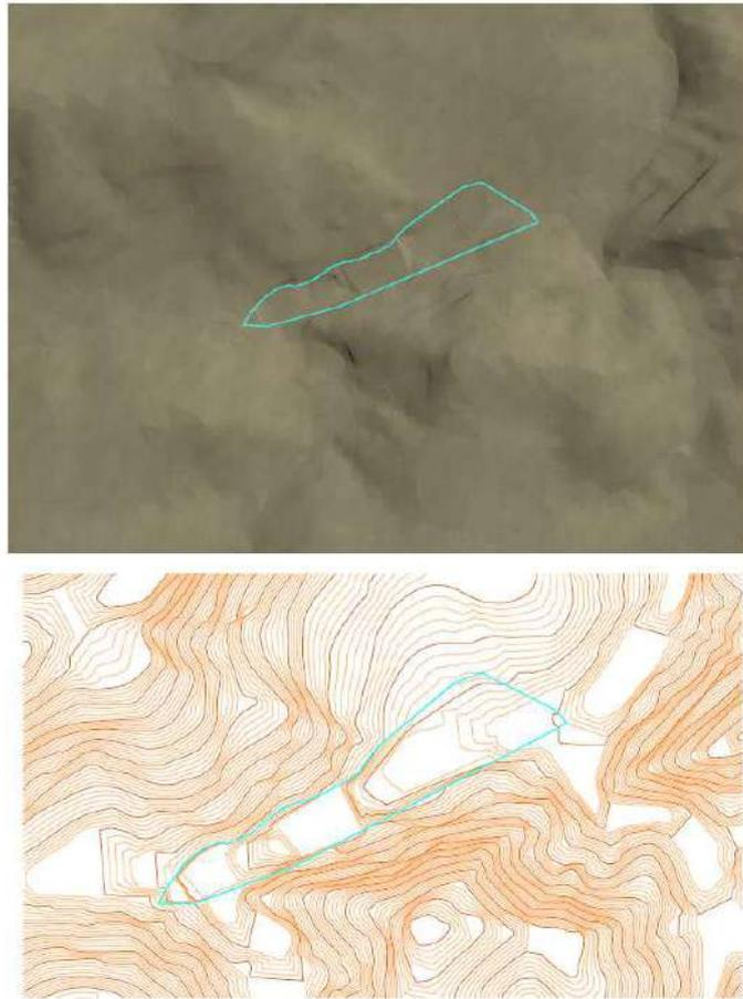
**Figura 76.** Simulación 3D y curvado de la Zona I de la Ampliación Segunda a “Valdecastillo” nº 5470, tras su restauración, indicando en ambas imágenes con contorno azul.
