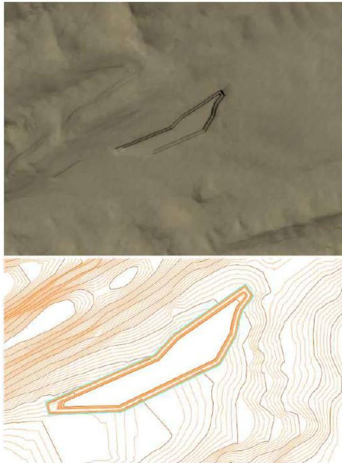
**Figura 74.** Simulación 3D y curvado de la Zona III de explotación de la Ampliación Segunda a “Valdecastillo” nº 5470, donde se puede observar lo que será el hueco teórico de explotación de dicha zona (cortorno azul en el curvado).
