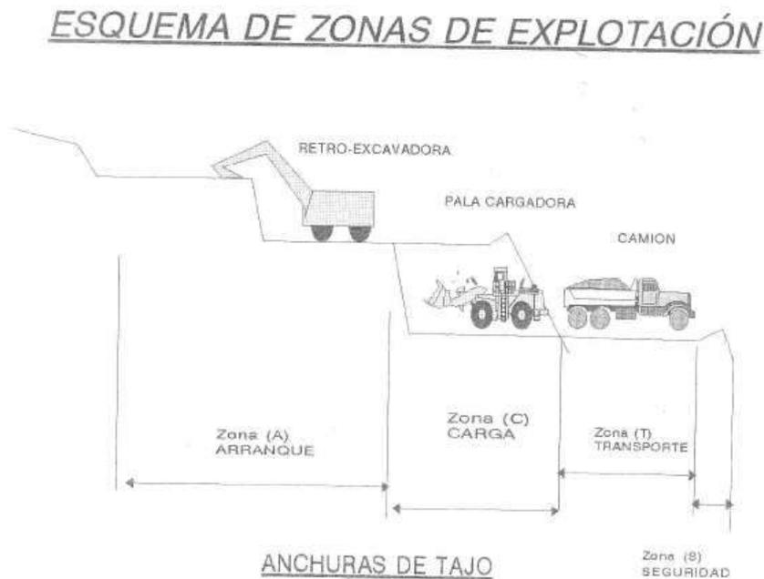
**Figura 68.** Esquema de explotación.
