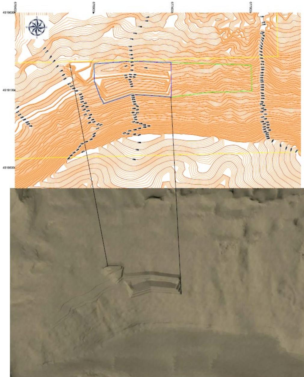
**Figura 25.** Hueco de explotación tras terminar la Fase IV con el área restaurada de la Zona 1 y simulación en-3D del hueco creado.
