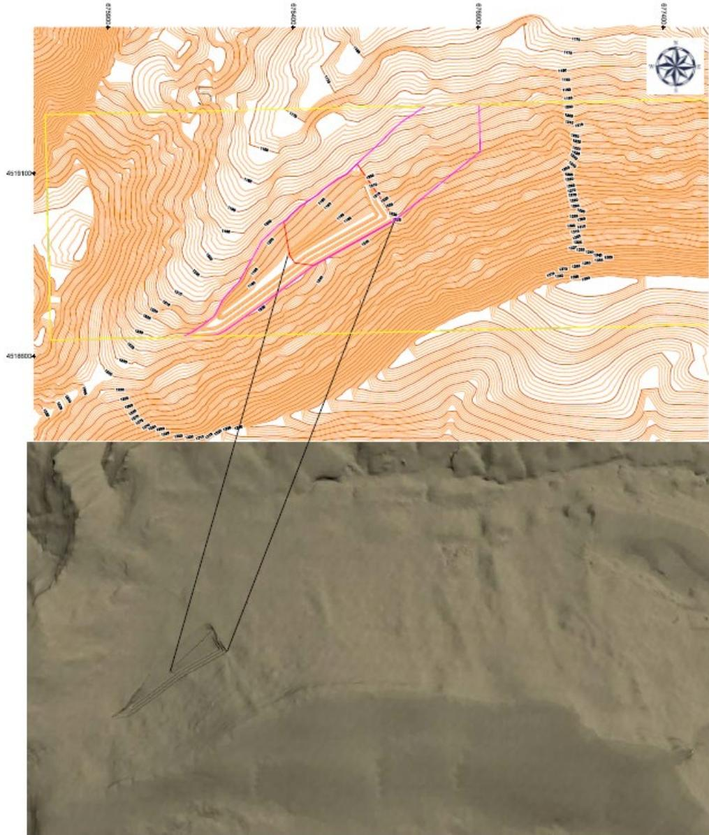
**Figura 21.** Fase II de explotación con hueco de explotación en color rojo y simulación 3D del hueco.
