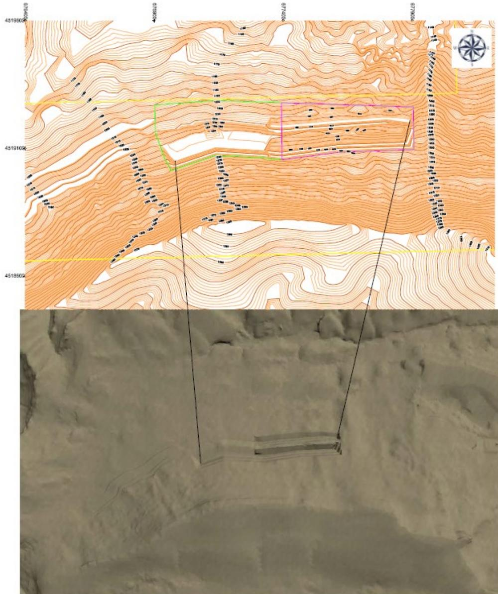
**Figura 27.** Hueco de explotación tras terminar la Fase V con el área restaurada de la Fase IV y simulación en-3D del hueco creado.
