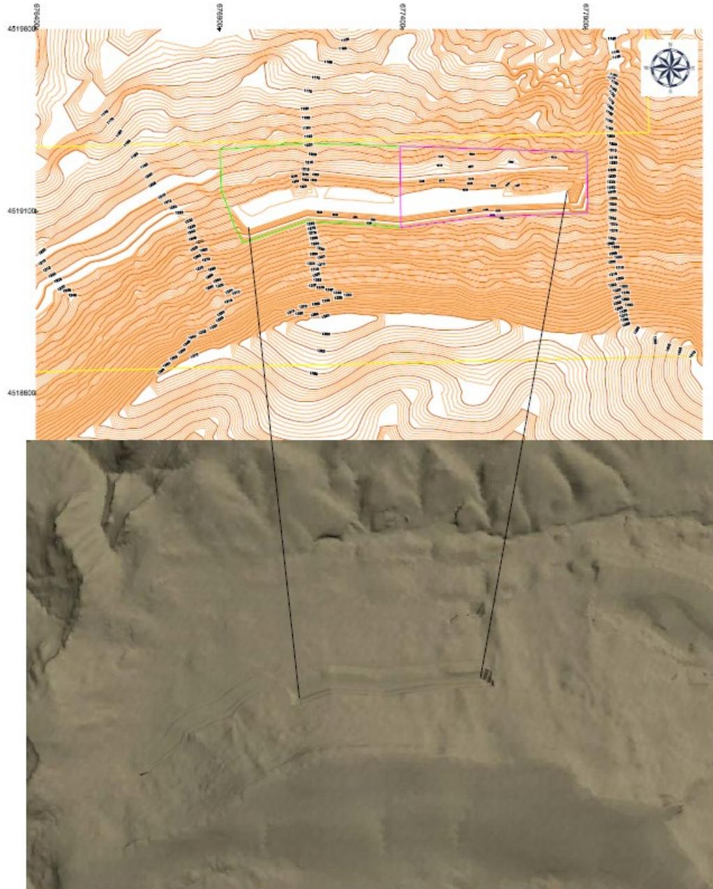
**Figura 28.** Hueco de explotación tras terminar la Fase V con el área restaurada de la Zona 1 y la Zona 2 y simulación en-3D del hueco creado.
