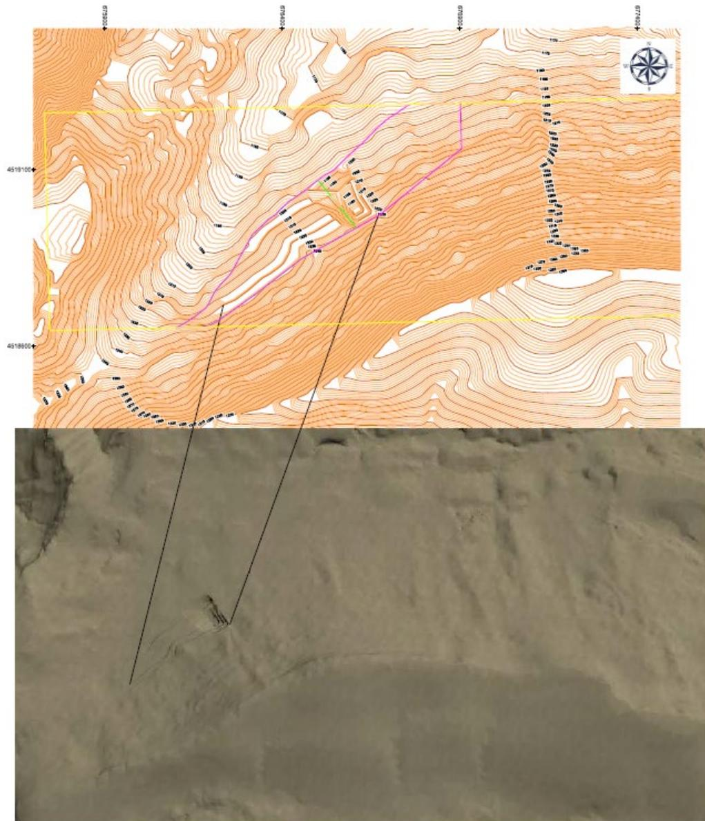
**Figura 23.** Hueco de explotación tras terminar la Fase II con la zona restaurada de la Fase I, indicada con el perímetro en color verde, y simulación en-3D del hueco creado.
