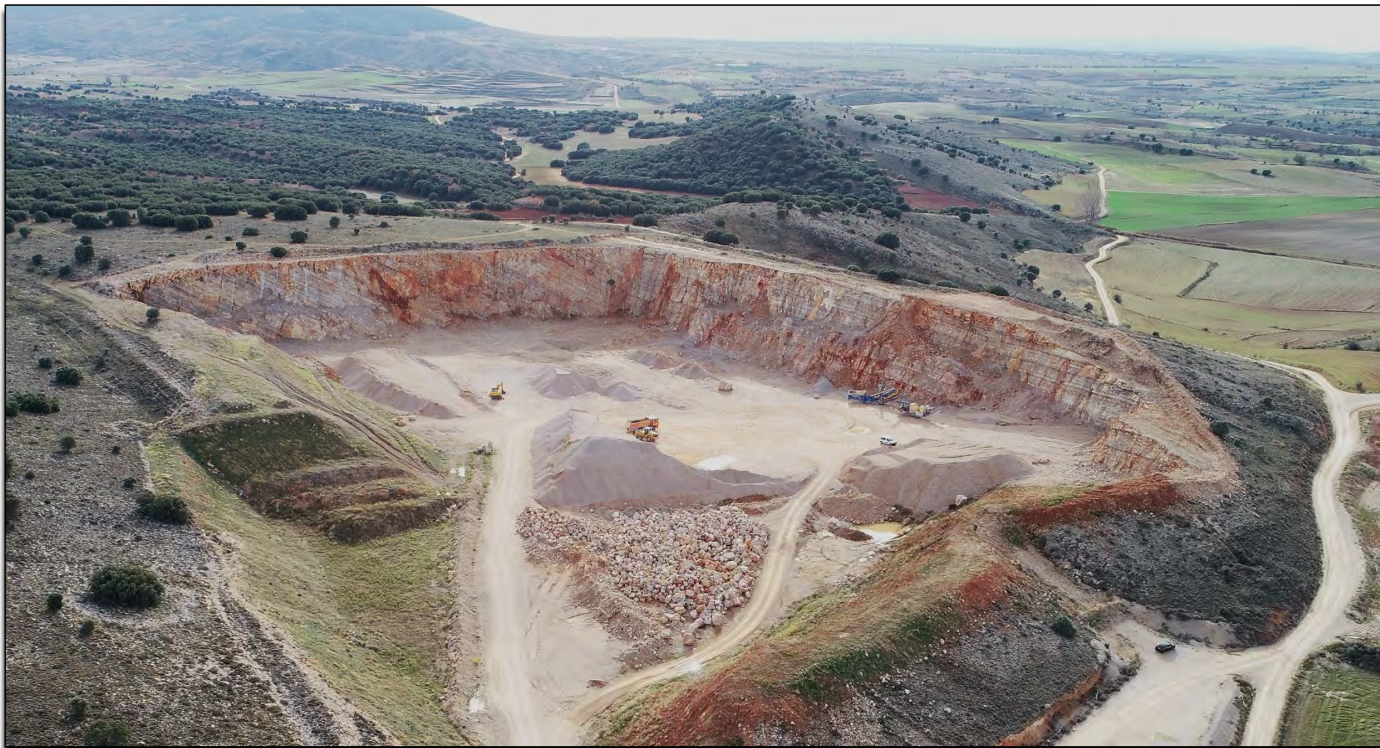
Figura nº 18. Aspecto de la alineación del Cretácico superior en la que se encuentra la cantera EL VALEJO, cuya ampliación se solicita. Se aprecia el buzamiento hacia el SO, como indica el I.G.M.E.
