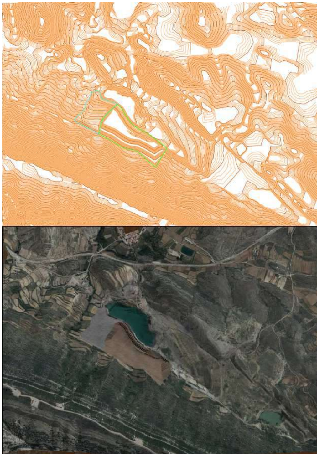
Figura 14. Simulación 3 D del hueco teórico de la Fase II de (en color verde en el curvado y trama marón en la simulación) junto a la zona restaurada de la Fase I (en color azul en el curvado y trama gris en la simulación)
