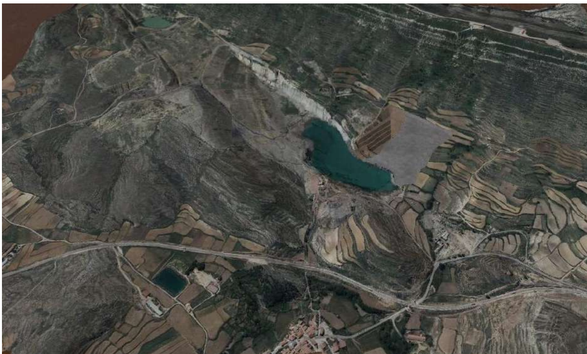
Figura 13. Vista desde el noroeste de la simulación 3D con la zona restaurada en color gris, con una topografía acorde al entorno y zona en explotación hacia la denominada Fase II en color marrón.
