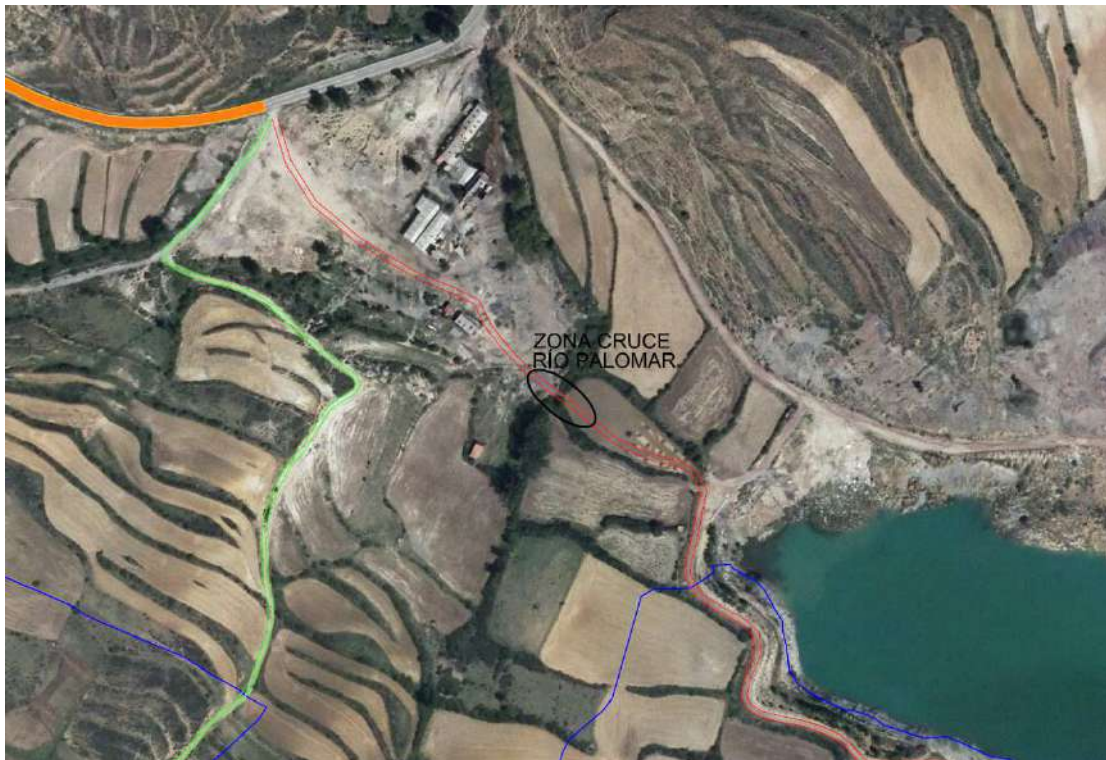
Figura 7. Detalle de la zona donde se ha de cruzar el Río Palomar por un paso ya existente que habrá que acondicionar para acceder al campo de cultivo sobre el que se trazará el camino que conectará con el ya existente al este de este campo.
