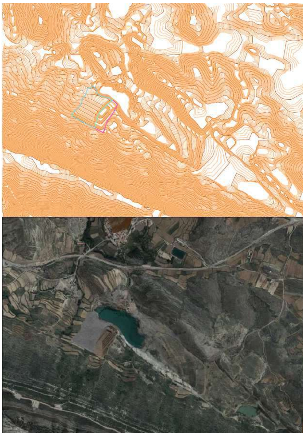
Figura 12. Restauración de la Fase I de explotación con hueco de explotación en color magenta en el curvado y trama gris en la simulación 3D. La trama en marrón se corresponde con la zona de explotación que no se puede restaurar para facilitar la prolongación de la explotación hacia el este en la denominada Fase II.
