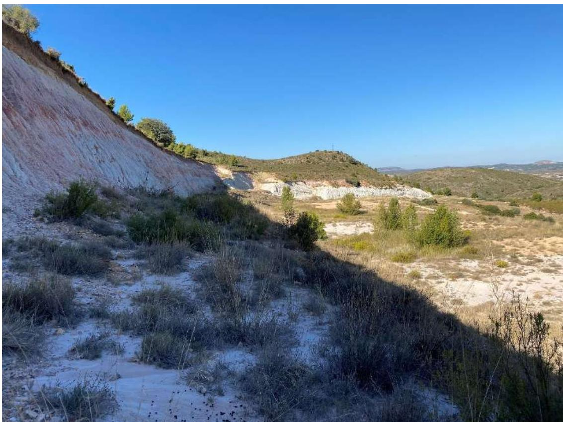
Foto 2: Vista de la zona a explotar desde el Este. En primer término, arcillas rojas y gris a techo del paquete productivo. Zona central y derecha, talud y plataformas restauradas de la antigua explotación
