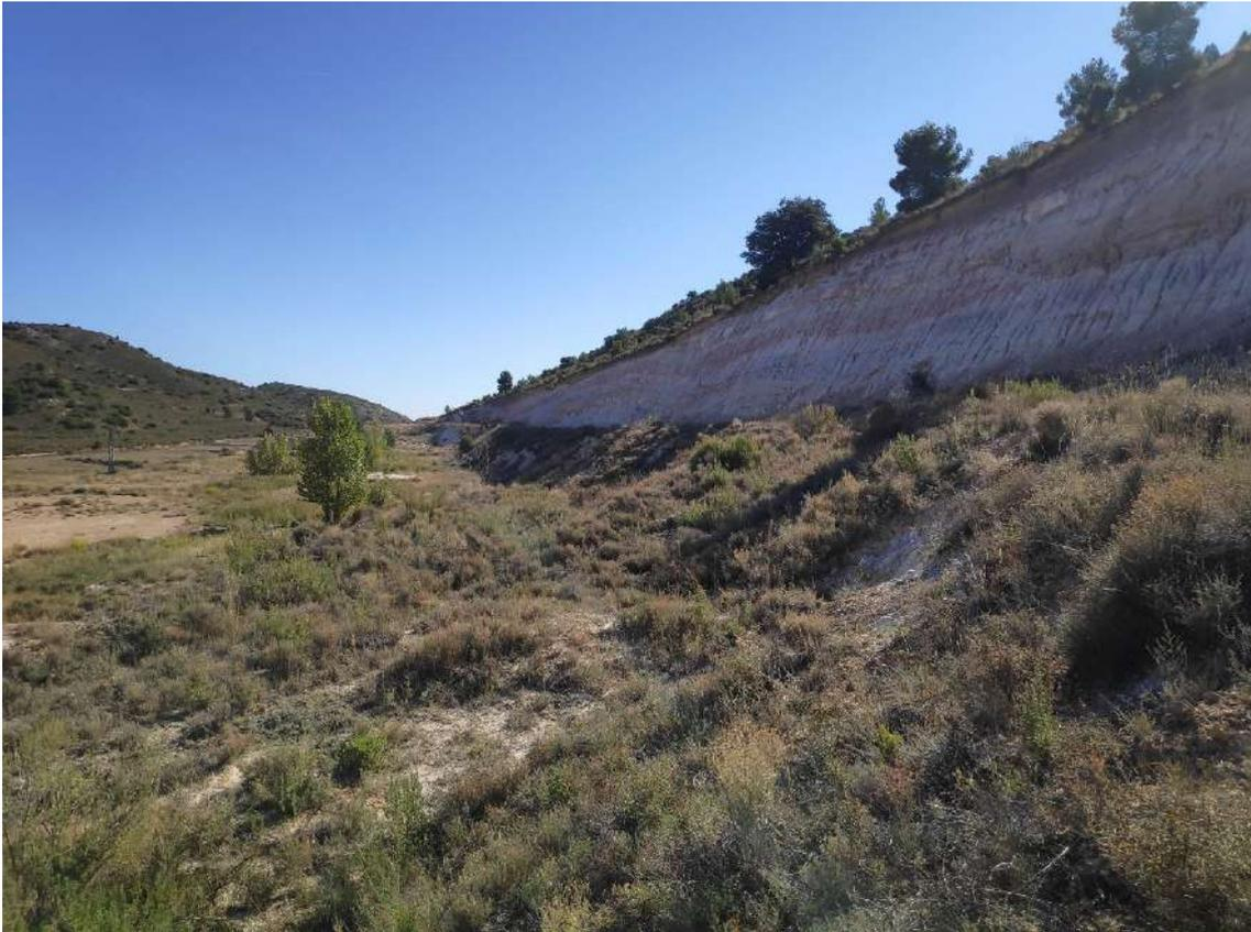
Foto 3: Vista de la zona a explotar desde el Este. En primer término, arcillas rojas y gris a techo del paquete productivo. Zona central y derecha, talud y plataformas restauradas de la antigua explotación
