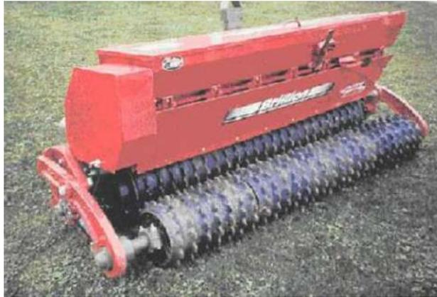
Figura 105: Sembradora para pratenses con rodillos acanalados. Fuente: Ministerio de Agricultura, Pesca y Alimentación
