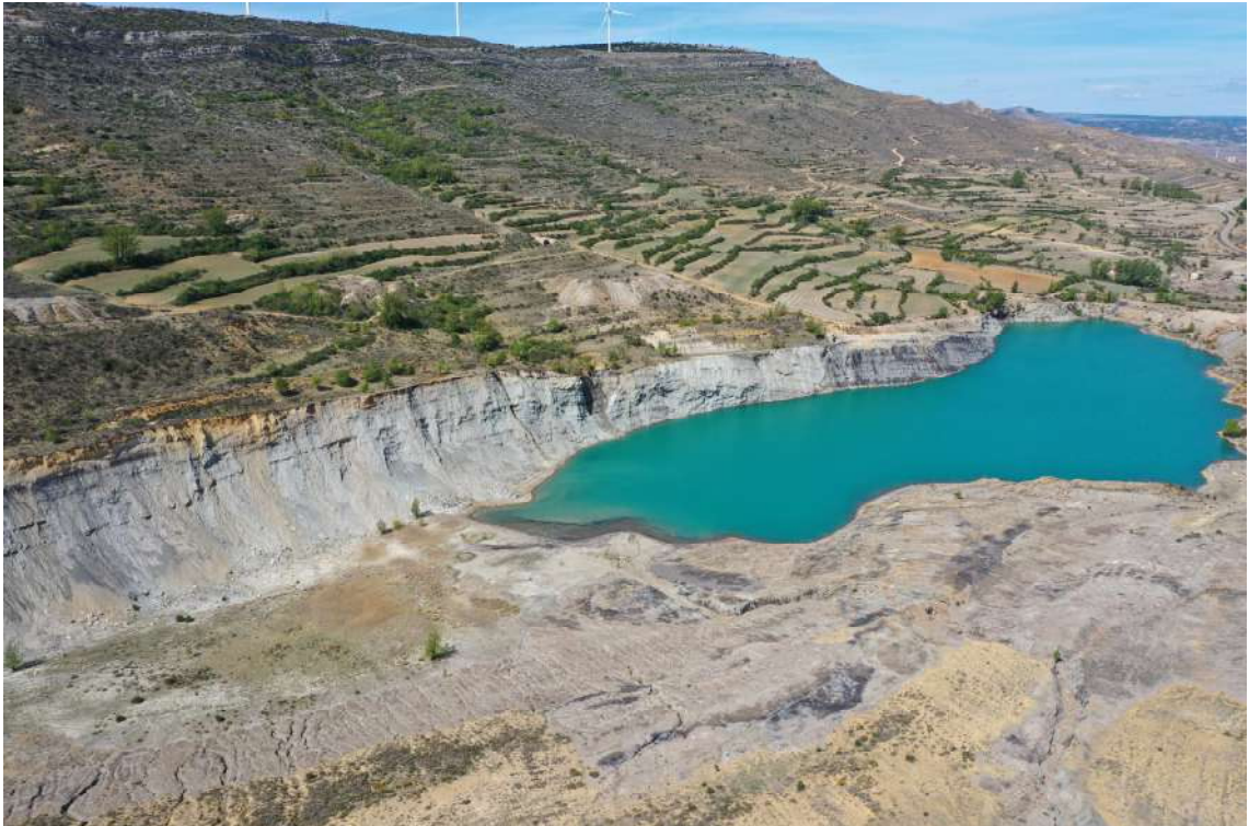
Foto 12. Antiguas escombreras sobre la ladera de San Just donde se realizará la Fase II de explotación de la zona 1, y donde inicialmente se hará el acopio de estériles.
