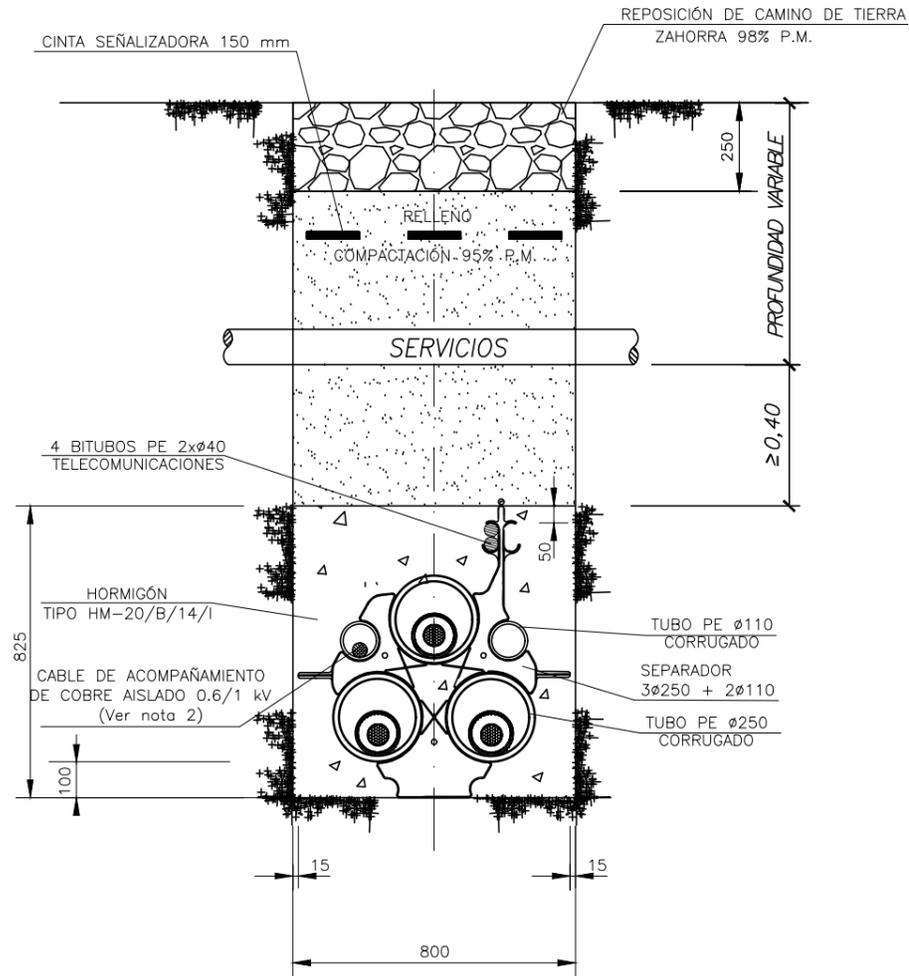
ZANJA PARA UN CIRCUITO DE ALTA TENSIÓN
