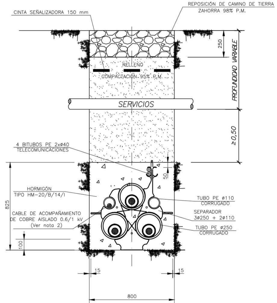
ZANJA PARA UN CIRCUITO DE ALTA TENSIÓN
