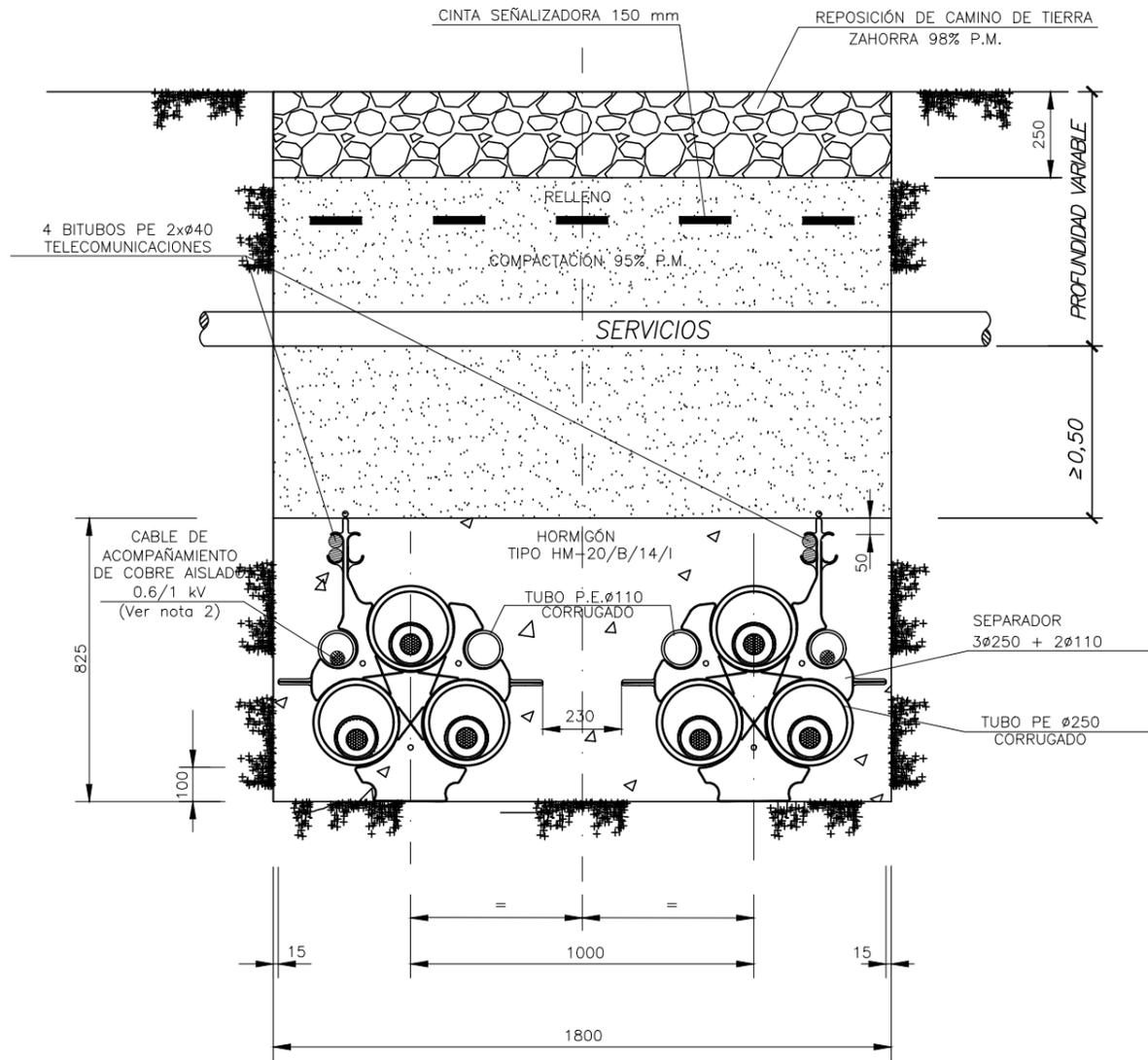
ZANJA PARA DOS CIRCUITOS DE ALTA TENSIÓN
