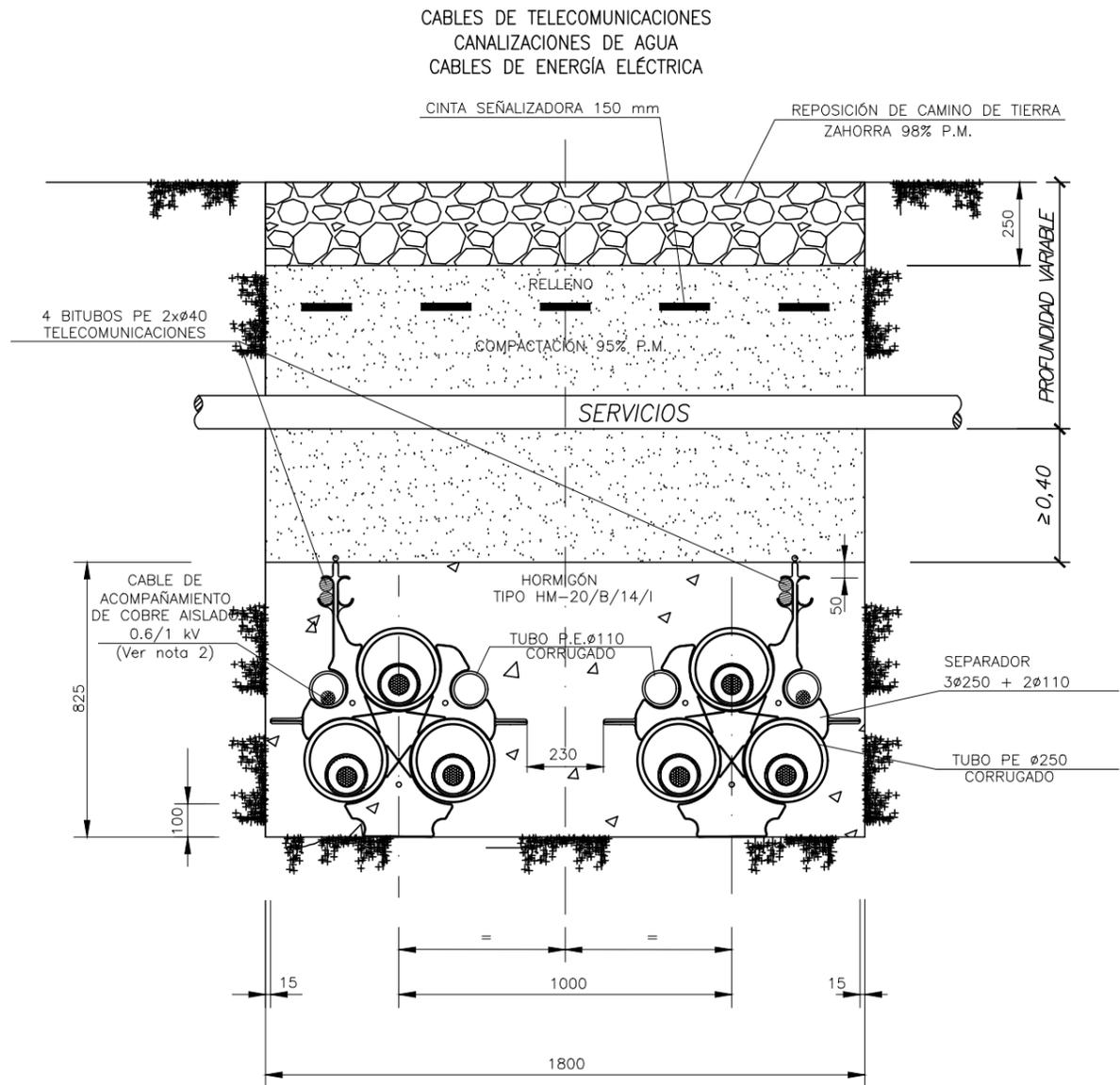
ZANJA PARA DOS CIRCUITOS DE ALTA Tensión
