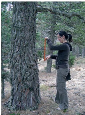
Foto 38. ▲ En el caso de ejemplares vivos la muestra que contiene la secuencia de anillos de crecimiento se extrae mediante una barrena hueca de 5 mm de sección y 400 mm de largo. La herida producida en el árbol es sellada con una pasta antibacteriana para evitar el deterioro del ejemplar. En la imagen, extracción de una muestra en la Sierra de Gúdar. Foto MASS
