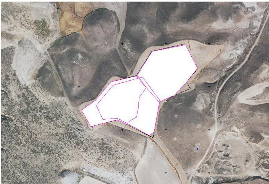
La altura total de la explotación es variable, ya que el terreno natural no siempre es completamente horizontal. En general se realiza un banqueo con un primer nivel de 2 mts aproximadamente de zahorras, y cinco bancos de unos 3 mts en explotación. Estos bancos son variables o muy variables en base de las intercalaciones arenosas que pueden aparecer entre los niveles de grava que obligan a su extracción diferencial.
