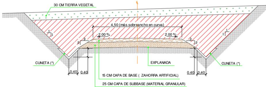
*Ilustración 12 Sección tipo viales para pendientes < 10%. Vial primario.*
