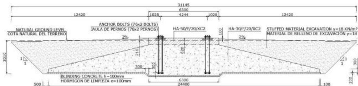
Ilustración 19 Sección de la cimentación: dimensiones establecidas.
