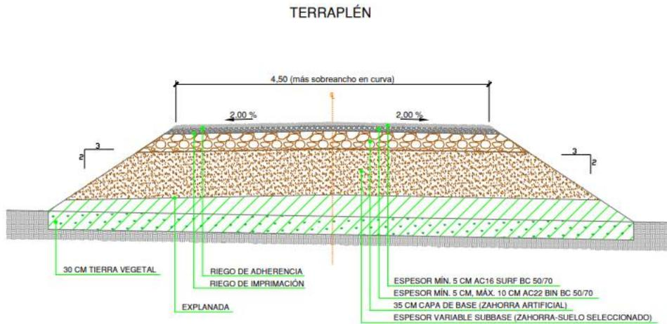
Ilustración 11 Sección tipo viales para pendientes < 10%. Vial Aglomerado
