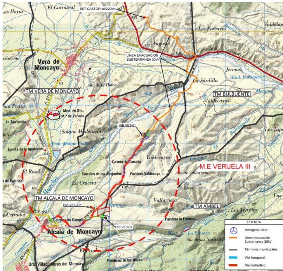
Ilustración 4 Emplazamiento general del Módulo Eólico Veruela III
