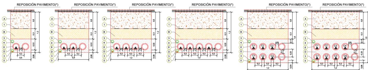
Ilustración 22 Zanjas para circuitos directamente enterrados bajo viales o drenajes.
