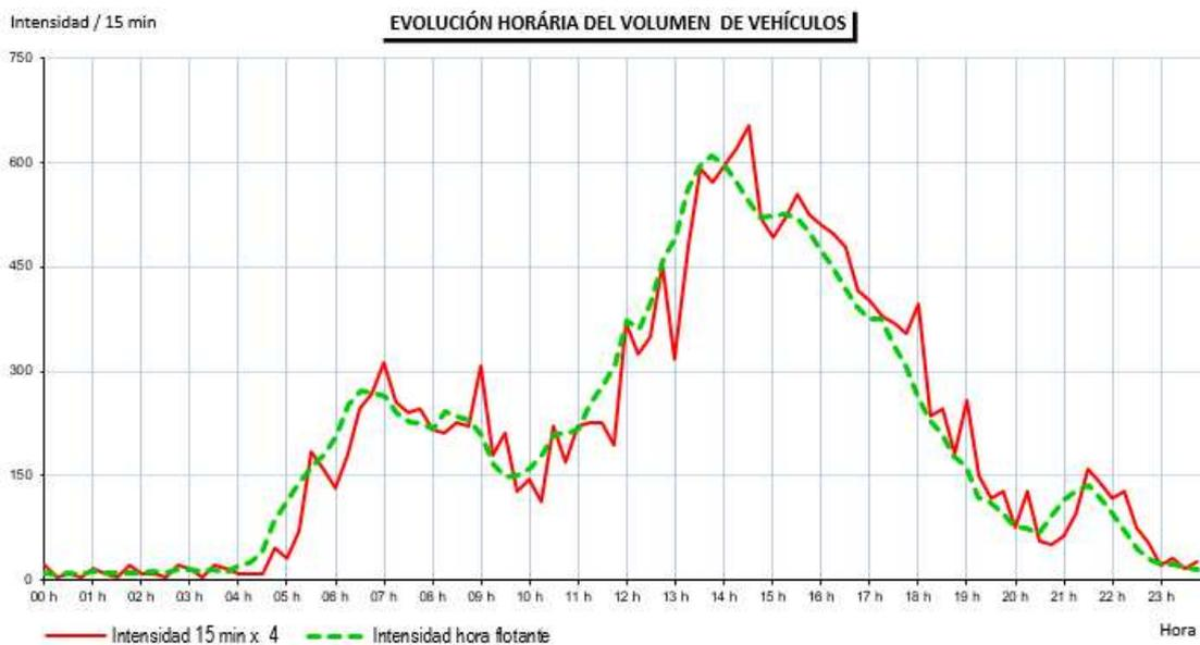
Ilustración 40: Aforos automáticos N-2 sentido C.A. Fuente: Doymo
