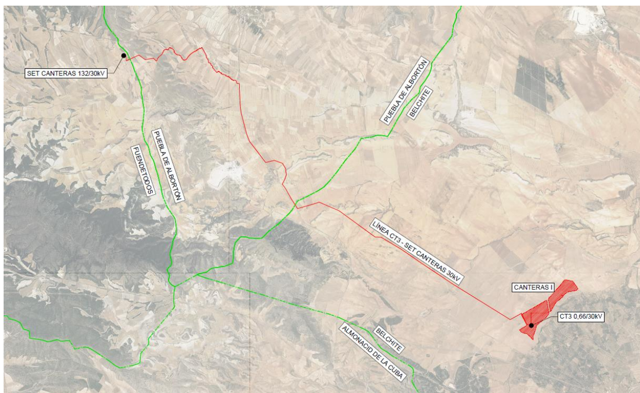
Ilustración 4: Trazado de línea de evacuación a SET
