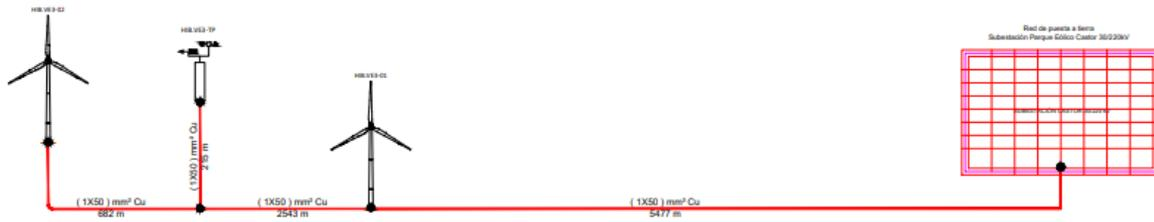
Ilustración 26 Red de puesta a tierra del módulo eólico Veruela III
