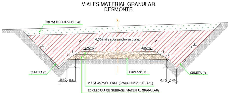
*Ilustración 13 Sección tipo viales para pendientes < 10%. Vial primario.*
