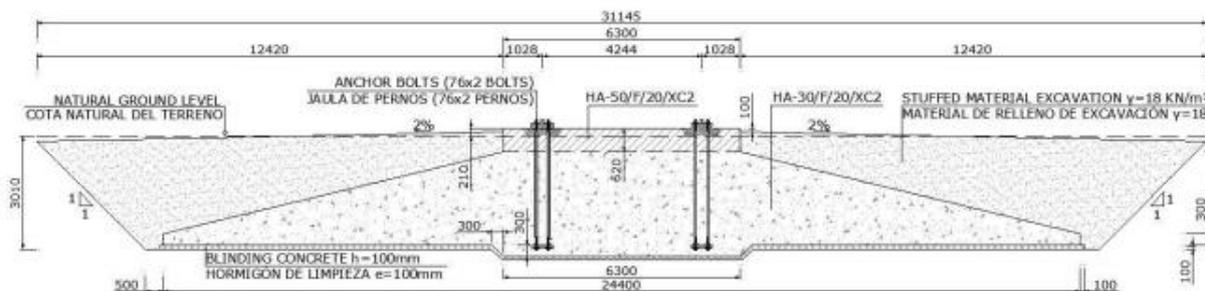
*Ilustración 20 Sección de la cimentación: dimensiones establecidas.*
