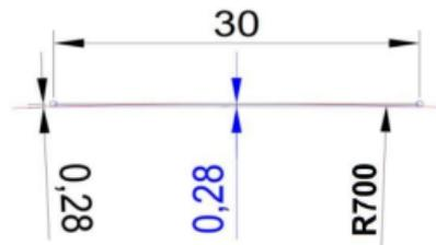
*Ilustración 15 Tolerancia irregularidades del suelo.*
