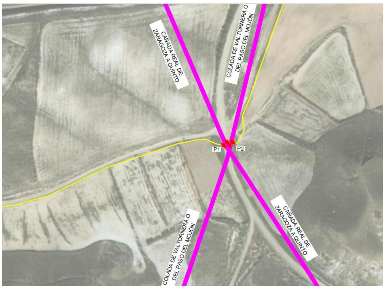
*Ilustración 7: Detalle cruzamientos de línea de evacuación con cañada real de Zaragoza a Quinto Colada de Valtornera o del Paso del Mojón*
