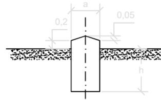
Las cimentaciones de los apoyos serán de hormigón en masa HM-20/B/20/I, de una dosificación de 200 Kg/m<sup>3</sup> y una resistencia mecánica de 200 Kg/m<sup>2</sup>, del tipo monobloque o fraccionada en cuatro macizos independientes (según proyecto).
