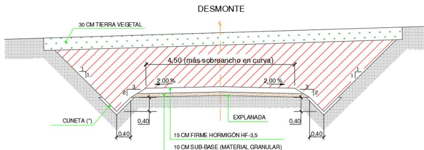
*Ilustración 12 Sección tipo viales para pendientes >14%.*
