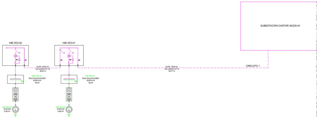
Ilustración 23 Esquema de conexión de los distintos aerogeneradores.
