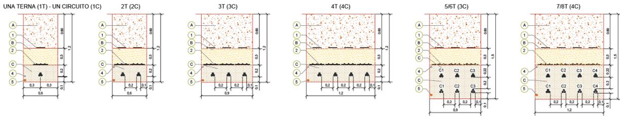
Ilustración 19 Zanjas para circuitos directamente enterrados.
