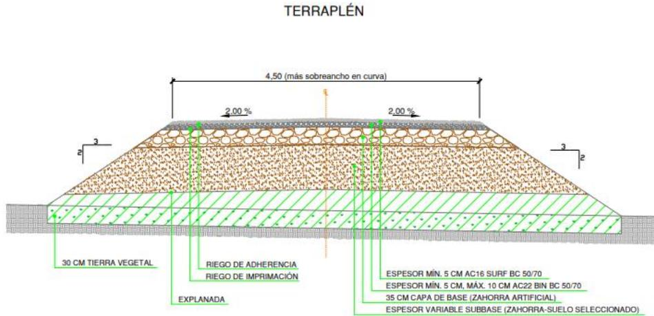
Ilustración 10 Sección tipo viales para pendientes < 10%. Vial Aglomerado
