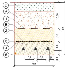
ZANJAS 18/30 KV CONDUCTOR ENTUBADO: BAJO VIALES/CAMINOS O DRENAJES
