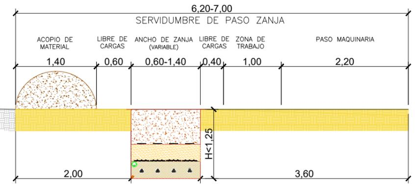
ZANJA RSMT 18-30 KV PARALELA A VIAL DE NUEVA EJECUCIÓN DESMONTE Y TERRAPLÉN
