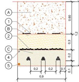
ZANJAS 18/30 KV CONDUCTOR DIRECTAMENTE ENTERRADO EN TERRENO AGRICOLA
