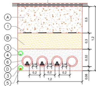
ZANJAS 18/30 KV CONDUCTOR ENTUBADO: BAJO CALZADA O ACERA EN ZONA URBANA
