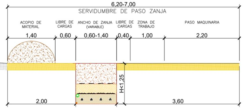
ZANJA RSMT 18-30 KV PARALELA A VIAL DE NUEVA EJECUCIÓN TERRAPLÉN
