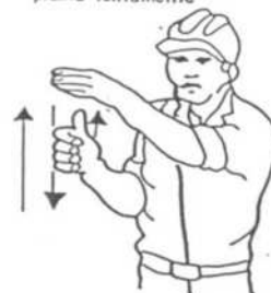
4 Levantar el aguilón o pluma lentamente
