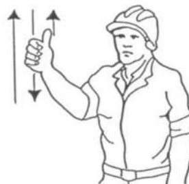
4 Levantar el aguilón o pluma lentamente
