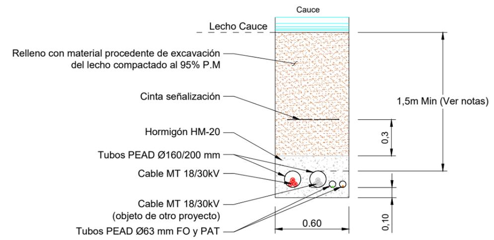
**2 DETALLE DE ZANJA EN CRUZAMIENTO - SECCION A-A'**
