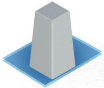
La ubicación definitiva de los hitos se realizará en la fase de construcción de la línea. Esta ubicación podrá ser acordada con el propietario de los terrenos por los que discurre la línea subterránea. En los planos de planta y perfil "as-built" de la línea se deberá indicar el punto exacto de ubicación del hito, acotándose las distancias mostradas en la placa de señalización posicionada en campo.
