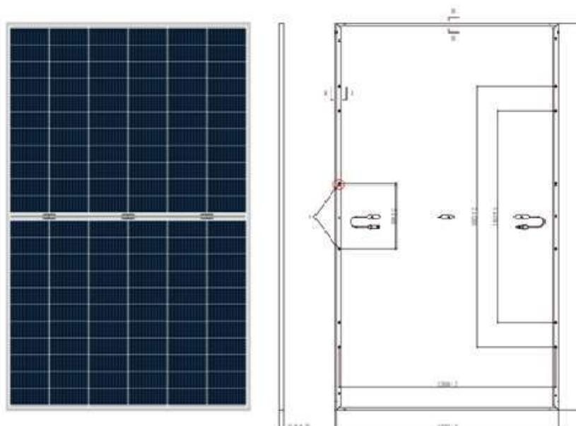
**Figura 7: Dimensiones del Módulo**
