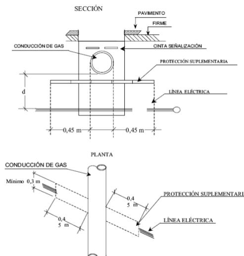
Figura 9 *Detalles de cruzamiento y conducciones (ITC-LAT 06).*
