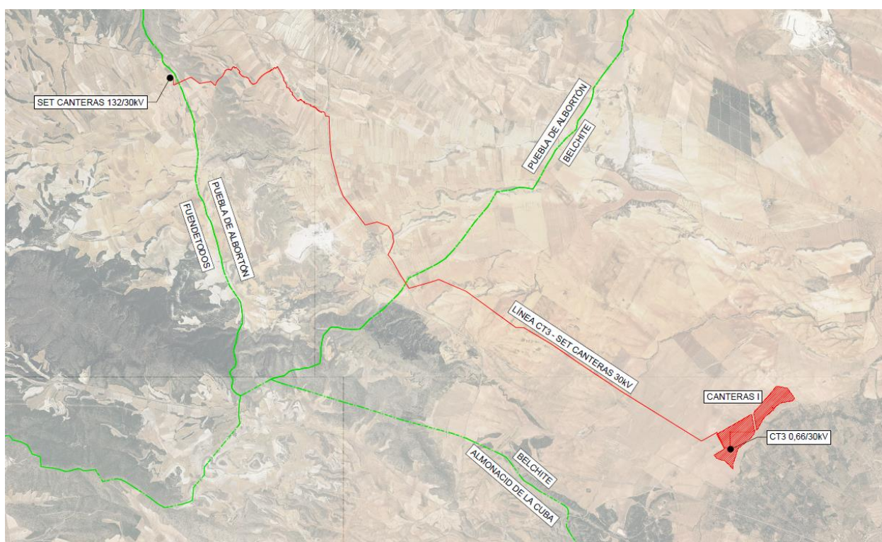
Ilustración 4: Trazado de línea de evacuación a SET
