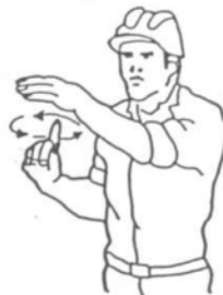
3 Levantar la carga lentamente
