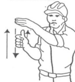
4 Levantar el aguilón o pluma lentamente
