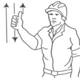
4 Levantar el aguilón o pluma lentamente
