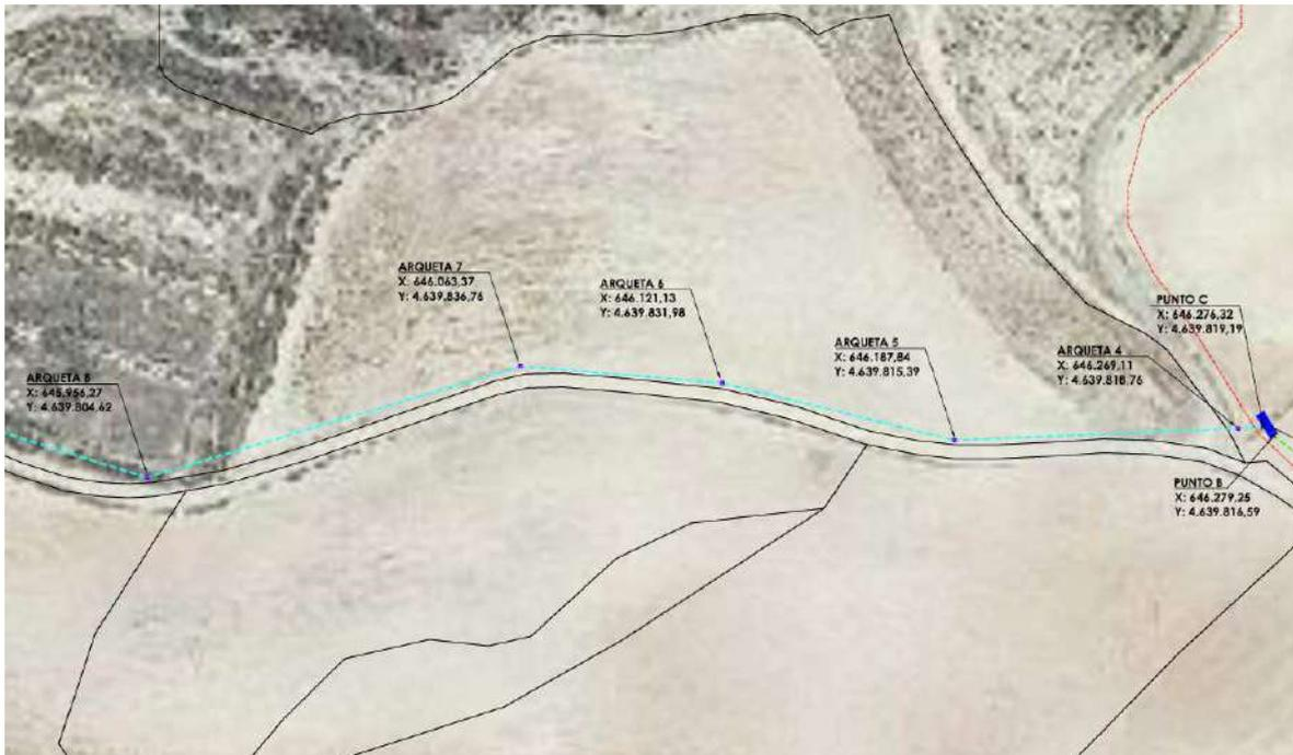
DETALLE 2 DE LOS ELEMENTOS RELEVANTES DE LA LSMT DE "PFV TRES MONTES" Y "PFV TRES MONTES II" DE 4.000 KW
