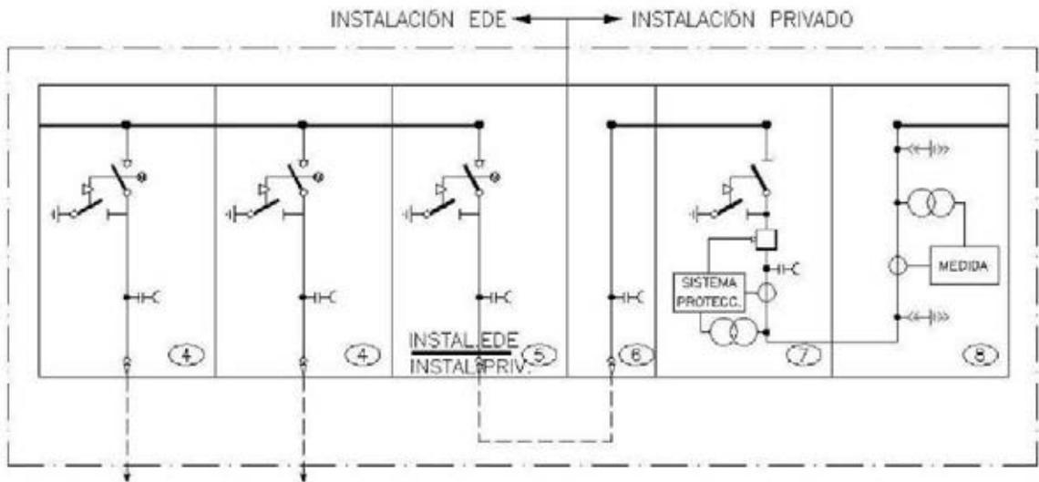
**10.5.2.2 Instalación de Celdas Parte C.S. (EDE): 3 IS + 1 CIS**
