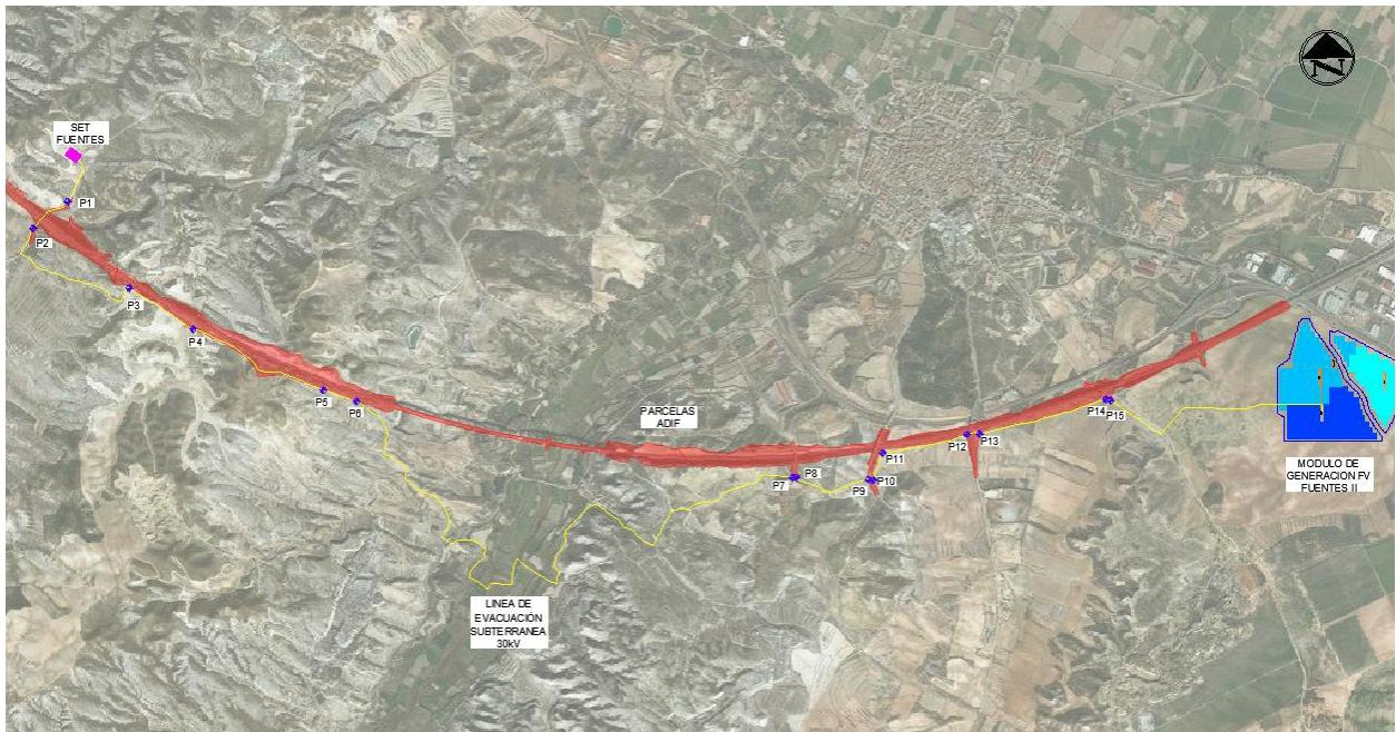
*Ilustración 5: Módulo de generación fotovoltaico Fuentes II, línea de evacuación y parcelas ADIF*
