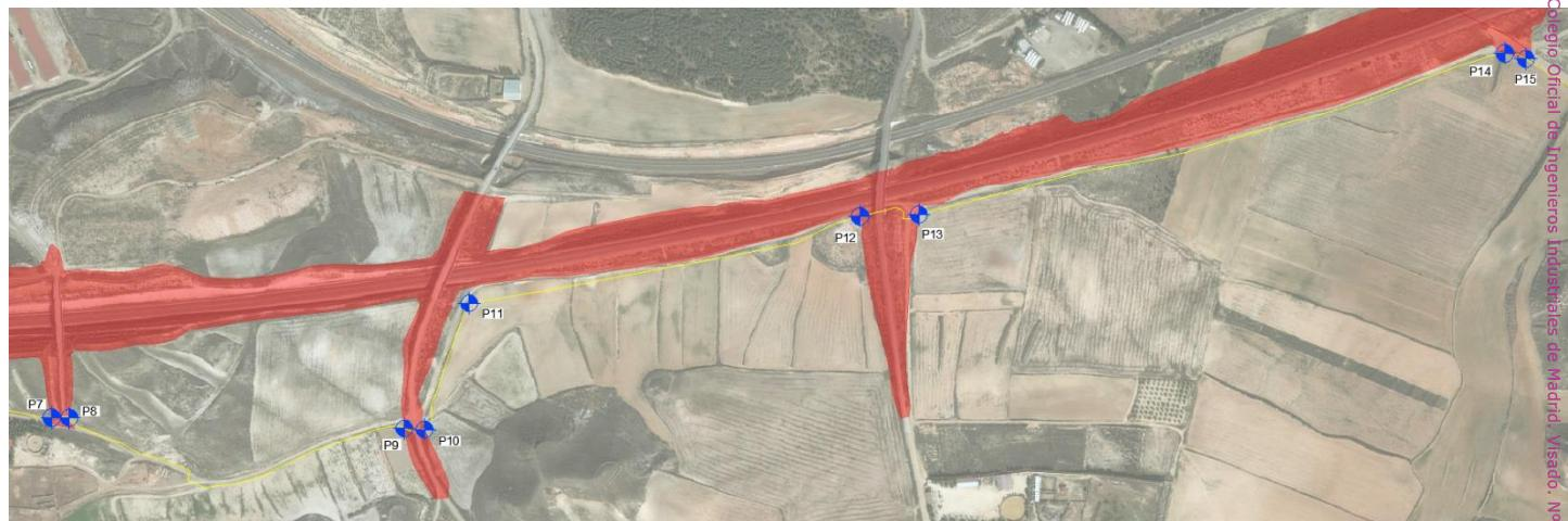
*Ilustración 8: Detalle cruzamientos P7, P8, P9, P10, P12, P13, P14 y P15, y paralelismo P11-P14 de la línea de evacuación del módulo de generación fotovoltaico con AVE Zaragoza*
