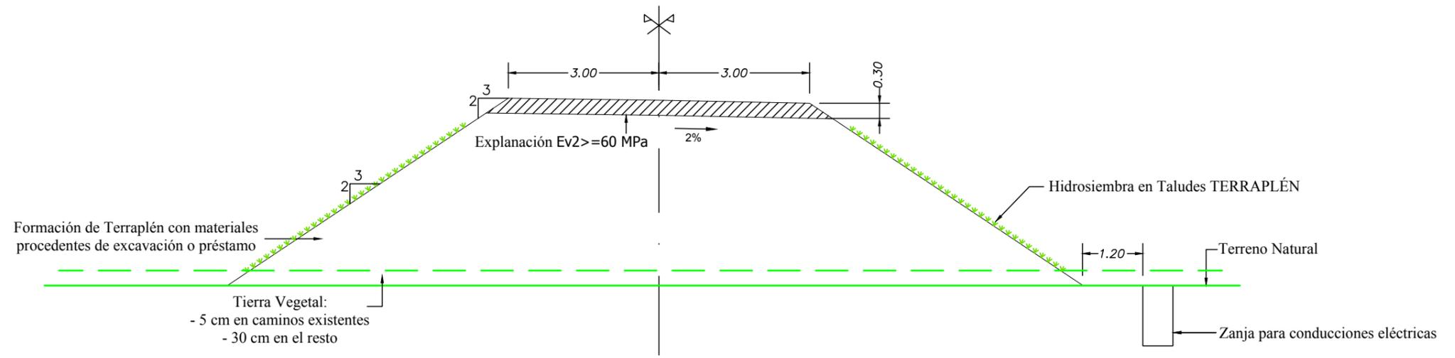
**SECCIÓN TIPO VIAL EN DESMONTE**
