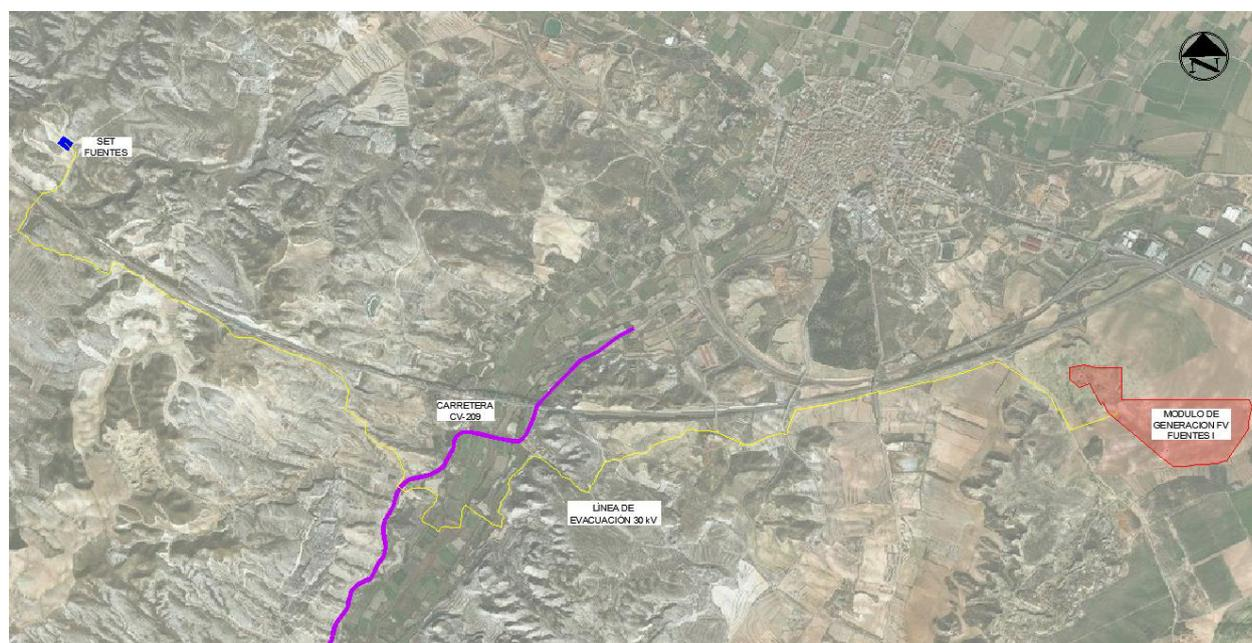
*Ilustración 5: Cruzamiento de la línea de evacuación con la carretera CV-209 mediante hinca*
