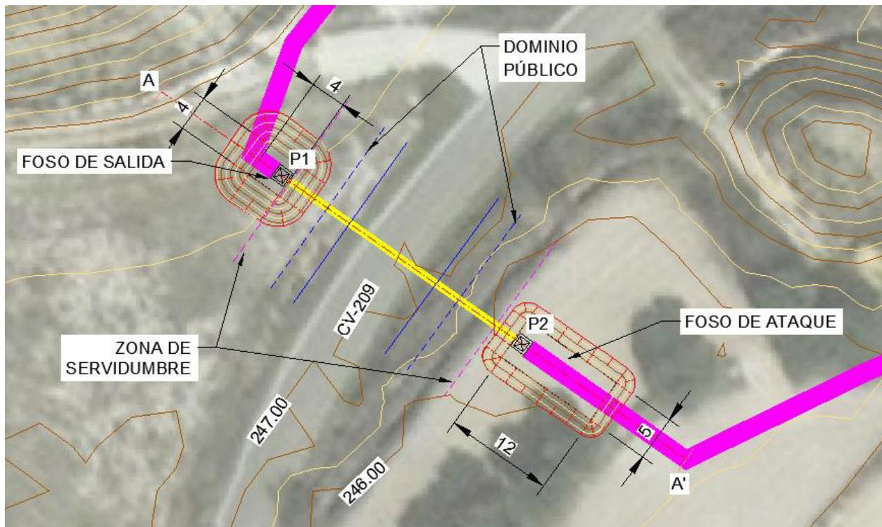
*Ilustración 6: Detalle cruzamiento mediante hinca*
