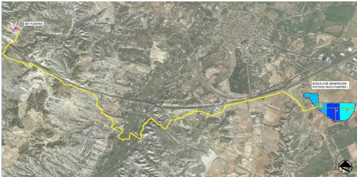
*Ilustración 2: Vista general del módulo de generación fotovoltaico y su línea de evacuación*
