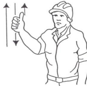
4 Levantar el aguilón o pluma lentamente
