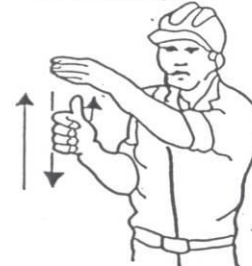
4 Levantar el aguilón o pluma lentamente
