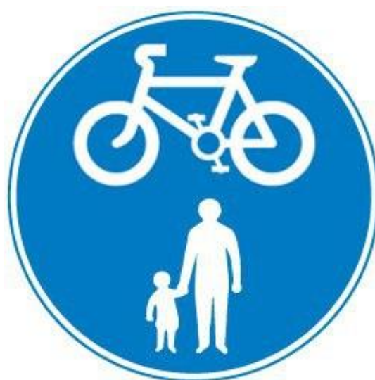
Figura 3. Señal S-322 vía de circulación compartida de peatones y ciclistas sin separación.
