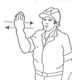
12 Avanzar en la dirección indicada por el señalista
