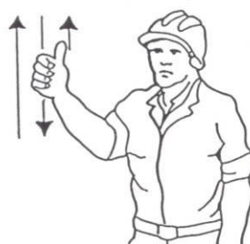
4 Levantar el aguilón o pluma lentamente
