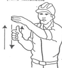
4 Levantar el aguilón o pluma lentamente
